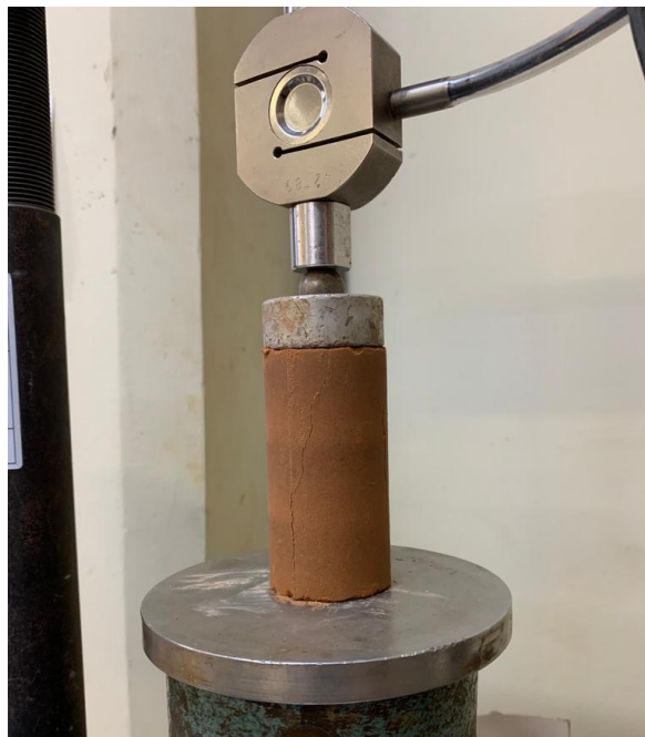
Figura 4.2 – Ensaio de resistência à compressão simples (Autora, 2022).
