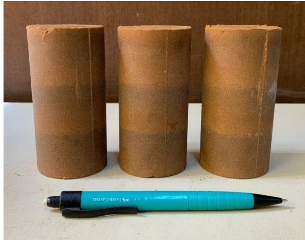
Figura 4.1 – Corpos provas moldados para o ensaio de resistência à compressão simples (Autora, 2022).
