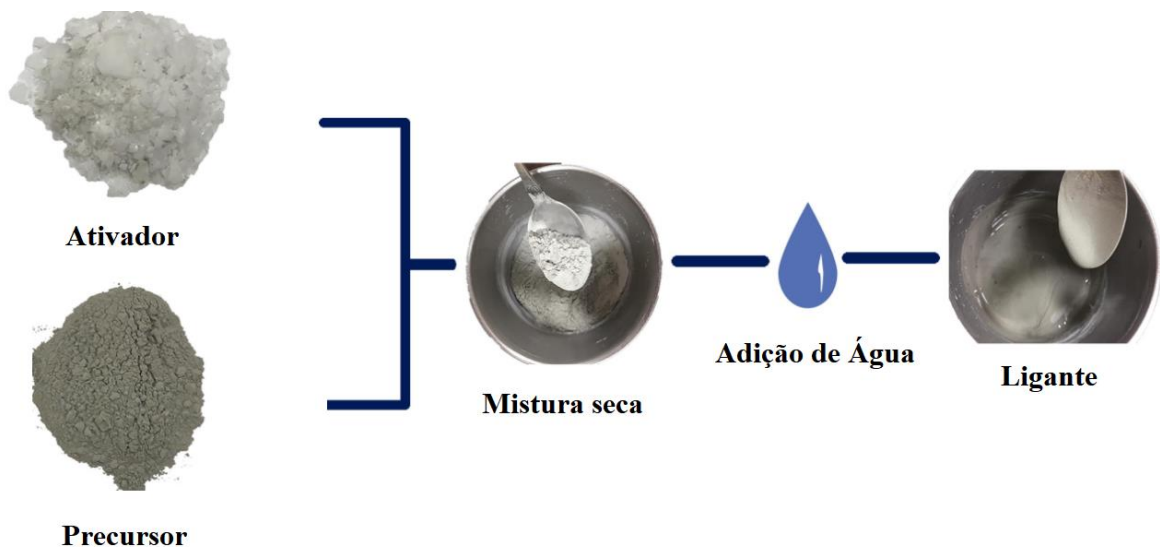
Figura 3.14 – Método one-part mix (Adaptado de Wu et al. , 2021),
