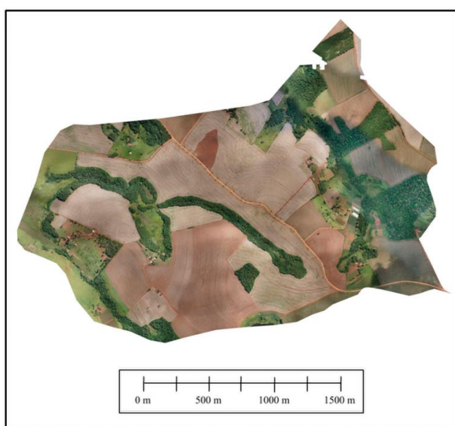
Figura 7. Ortomosaico formado a partir das imagens obtidas com o drone Arator 5B, no voo acompanhado no dia 26 de março de 2021. As imagens foram processadas no programa AgisoftMetashape.
