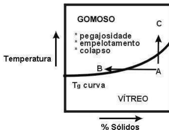
Figura 4. Diagrama representativo da transição entre os estados vítreo e gomoso para um material amorfo.
