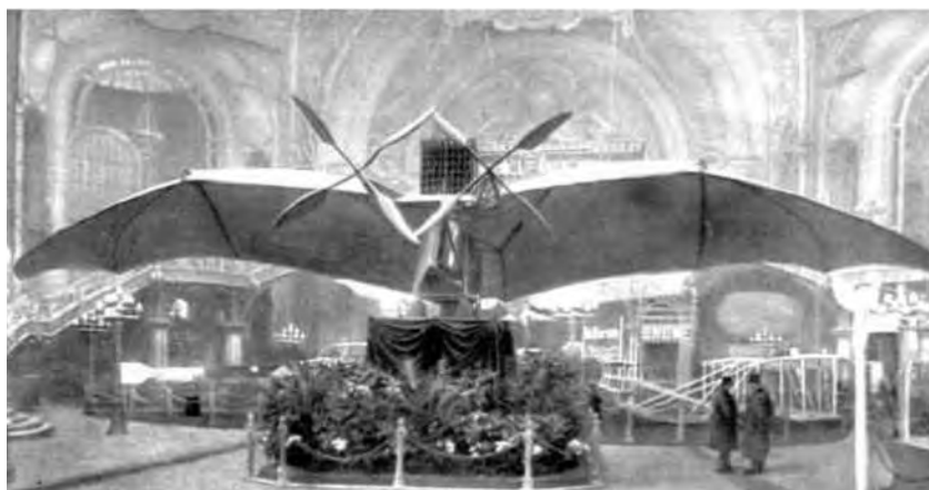
Figura 4.11 – Avion III , de Clément Ader. Dois motores a vapor de 20 CV.
