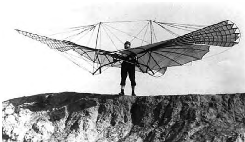
Figura 4.16 – Lilienthal preparando-se para um voo planado. Observem-se os extremos das asas, imitando as dos grandes pássaros ( pinions ).
