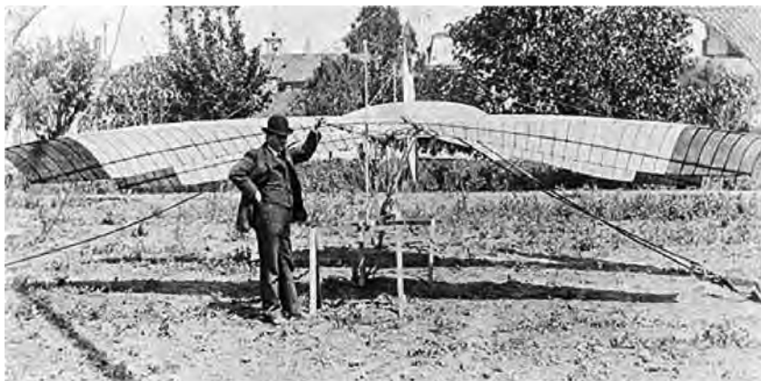
Figura 4.21 – Planador de Montgomery. Duas asas no mesmo plano, 1905.
