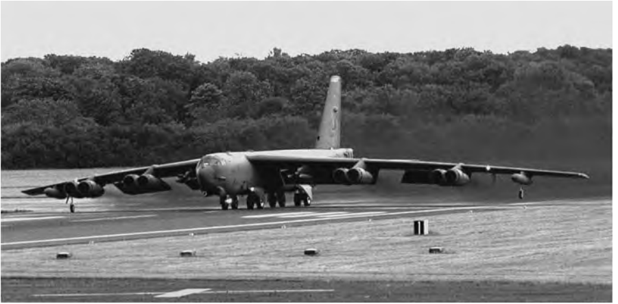
Figura 4.14 – Bombardeiro B-52 em terra. Asas encurvadas para baixo. Observem-se os apoios auxiliares, com pequenas rodas, quase nos extremos das asas.
