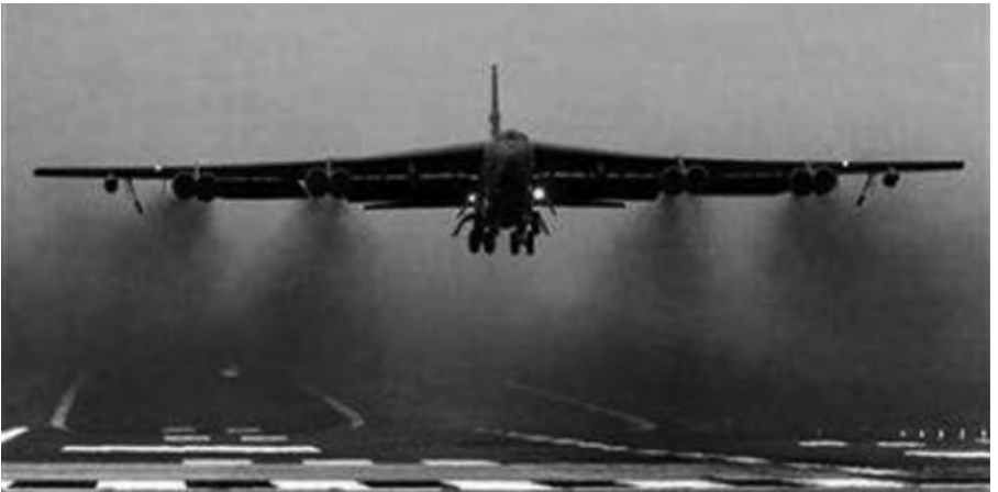
Figura 4.15 – Bombardeiro B-52 alcançando voo. Asas encurvadas para cima. As pequenas rodas auxiliares estão sendo recolhidas.
