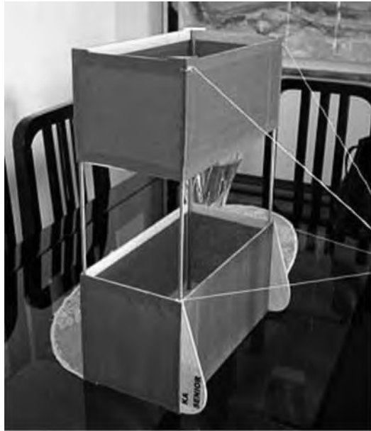
Figura 6.4 – Uma das pandorgas-caixa, inventadas e desenvolvidas por Hargrave.
