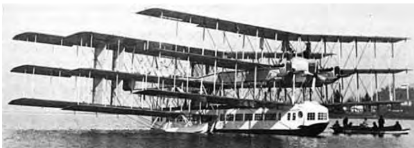
Figura 4.39 – Aeroplano com seis motores e nove asas. Projeto de Caproni, 1928.
