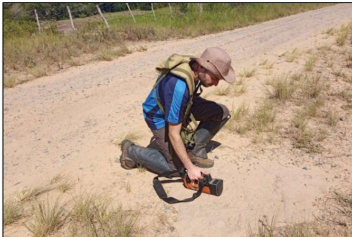
**Figura 11: Uso de gamaespectrômetro portátil em campo.**
