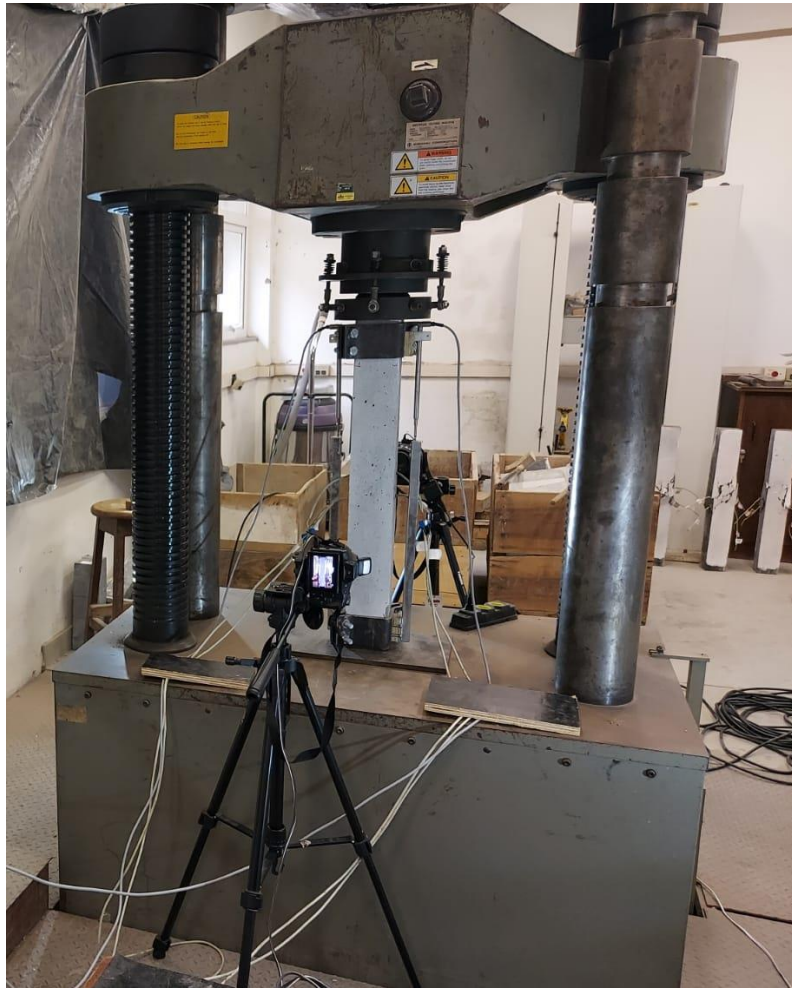
Figura 4.10: Pilar posicionado para ensaio com os mecanismos já instalados (AUTOR, 2022).
