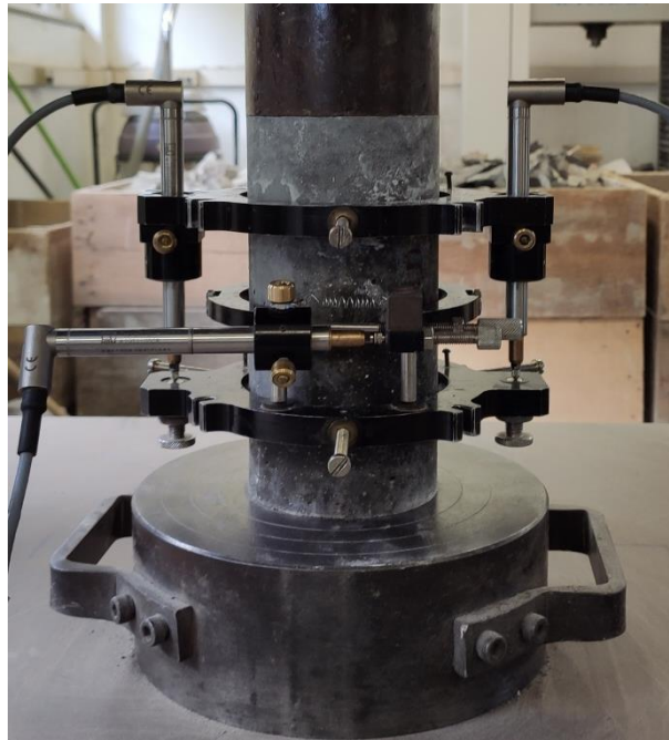
Figura 4.6: Ensaio de módulo de deformação (AUTOR, 2022).
