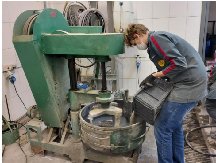
Figura 4.4: Colocação de componente no misturador de eixo vertical (AUTOR, 2022)
