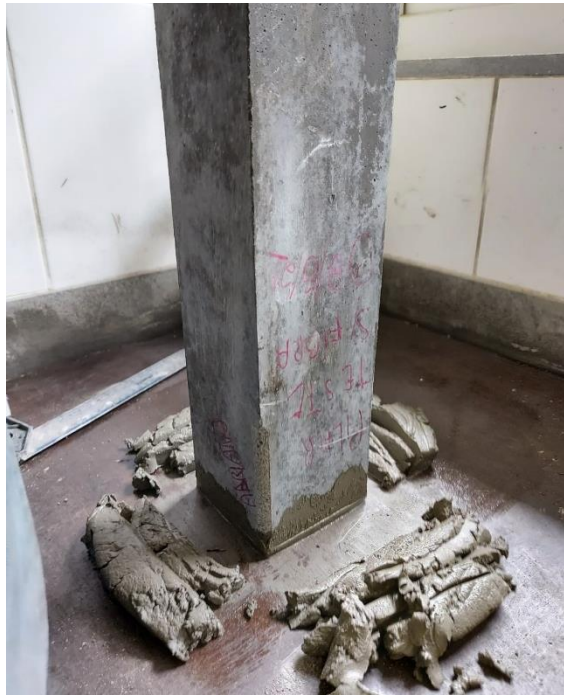
Figura 4.11: Capeamento da base do pilar (AUTOR, 2022).
