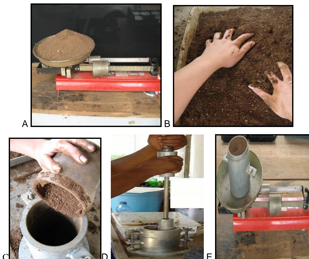
FIGURA 13. Ilustração de algumas etapas do ensaio Proctor Normal: (A) Pesagem da quantidade de solo necessária para cada teste; (B) Mistura homogênea do solo com água para obtenção do teor de água estipulado para a curva de compactação. (C) Adição do solo no cilindro, em camadas; (D) Aplicação dos 25 golpes sobre o corpo de prova; (E) Pesagem do cilindro + solo úmido.
