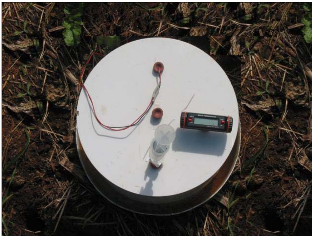
Figura 1. Foto do conjunto câmara-base utilizado para avaliação de óxido nitroso. Faculdade de Agronomia, UFRGS, Porto Alegre, RS.
