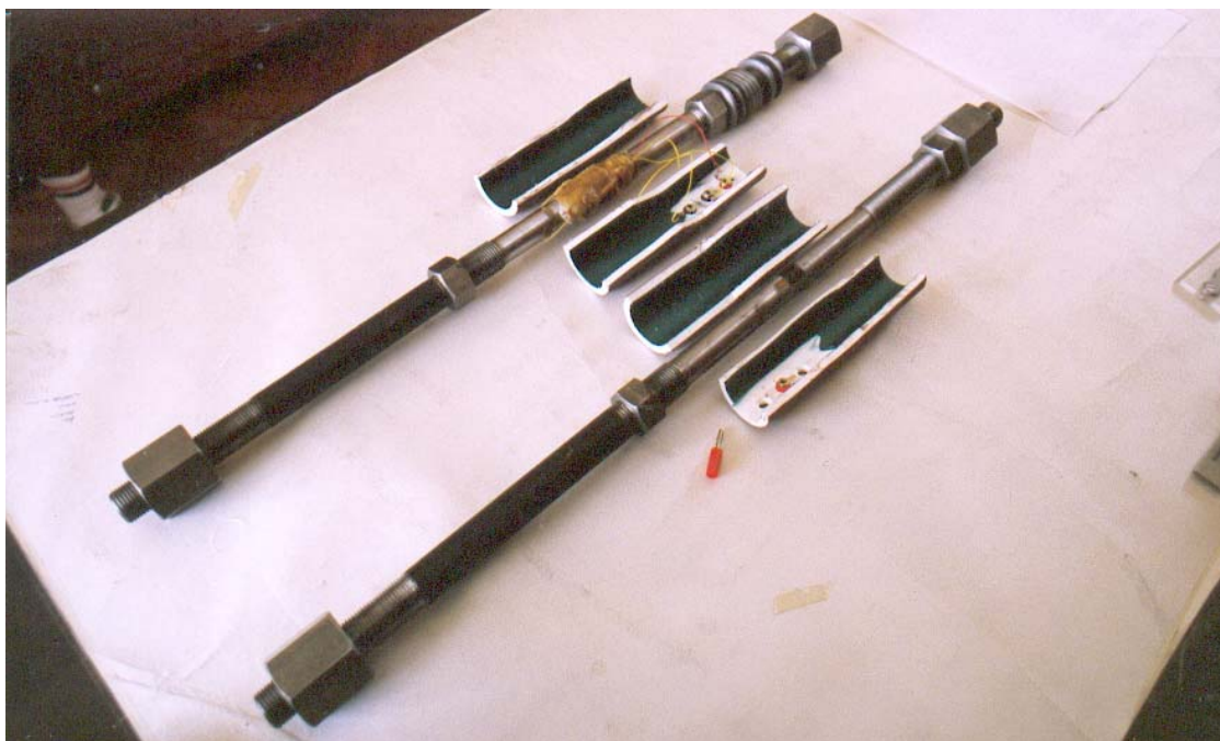
Figura 4.15 Barras instrumentadas no processo de instrumentação
