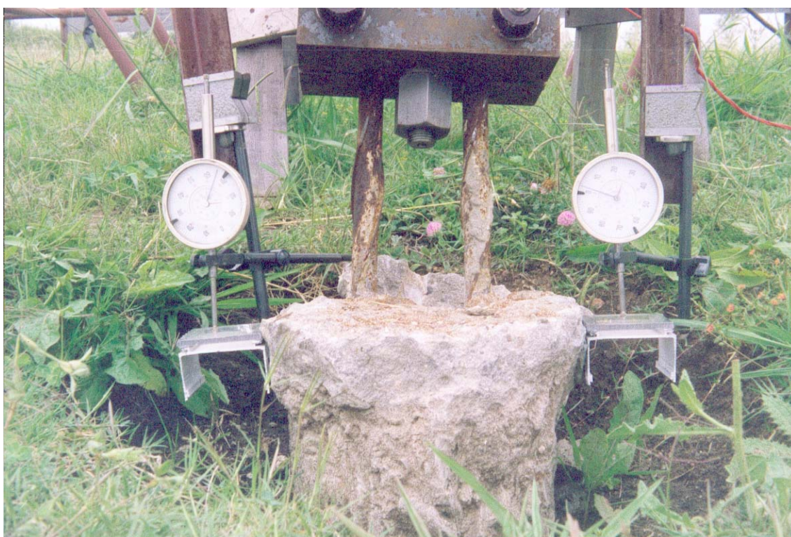
Figura 4.18 Vista parcial do sistema de medição de deslocamentos
