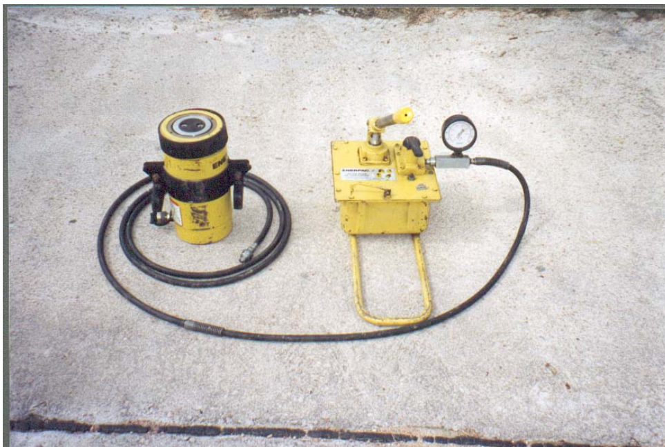
Figura 4.10 Cilindro e bomba hidráulica utilizados nas provas P13 a P18
