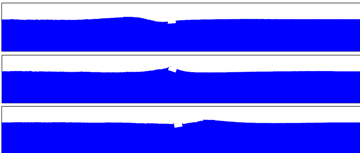
Figura 5.69: Registros de superfície livre de alguns instantes de tempo para o problema de pacote de onda interagindo com um corpo flutuante.
