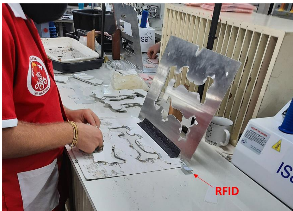
Figura 11: Colocação de peças em gabaritos de costura com RFID.
