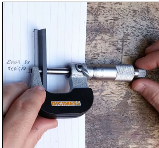
Figura 19 – Fotografia do Micrômetro utilizado para a medição da espessura dos corpos de prova
