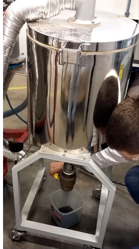
Figura 14 – Cilo para secagem da PA
