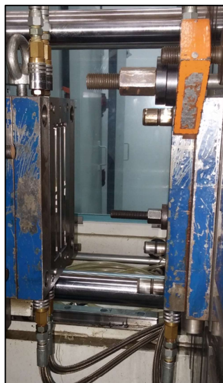
Figura 15 – Fotografia do molde de injeção
