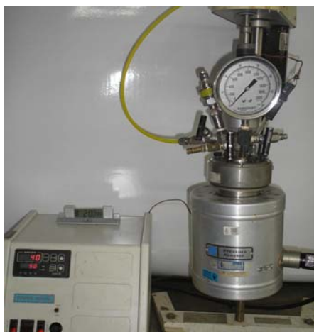
Figura 32. Reator Parr utilizado para as reações de otimização.
