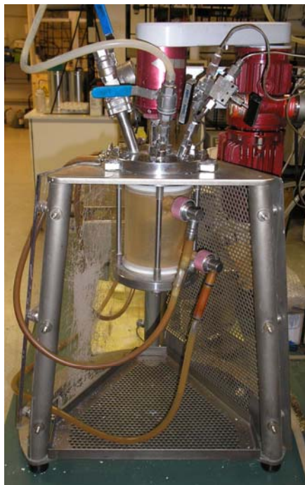
Figura 33. Reator Büchi utilizado nas reações para obtenção de polímeros em maiores escalas.
