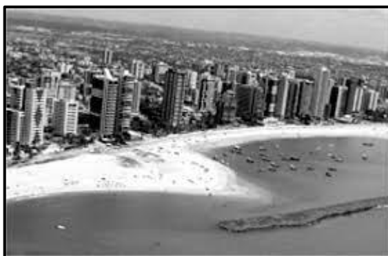
Figura 7: Acúmulo de sedimento a barlamar na Praia de Piedade, Recife (PE). (Fonte: CPRH)
