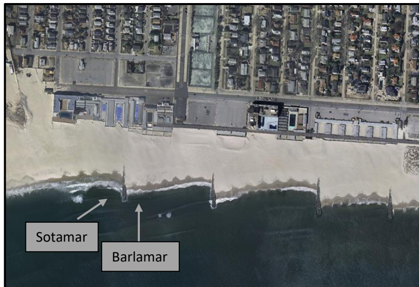
Figura 6: Identificação de transporte de sedimentos de sotamar para barlamar. (Fonte: modificado de “Blog do professor Edson”)
