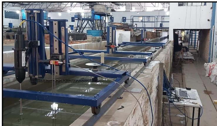
Figura 19: Posicionamento das sondas no canal (Fonte: Autora)
