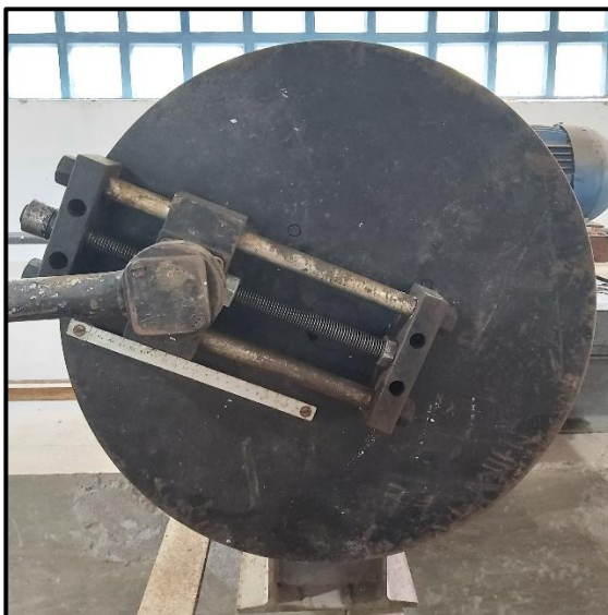
Figura 17: Mecanismo de ajuste do braço de alavanca (S) para a geração das ondas. (Fonte: Autora)
