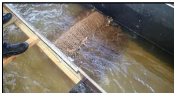
Figura 14: Conchas ensacadas sendo testadas. (Fonte: Coghlan et al. (2016))
