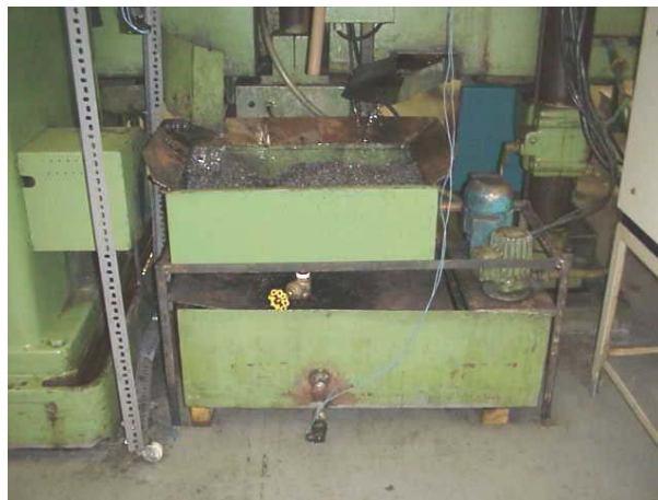
Figura 4.7: Sistema de peneira/tanque para lavagem dos cavacos.
