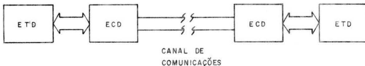
Figura 1 Componentes de uma ligação
