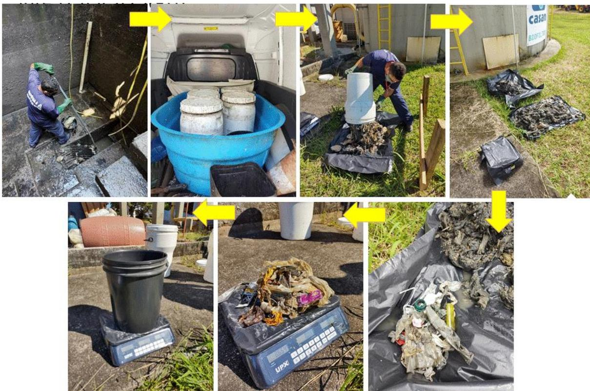
**Figura 6 – Composição de imagens para exemplificação das principais etapas do estudo gravimétrico realizado.**
