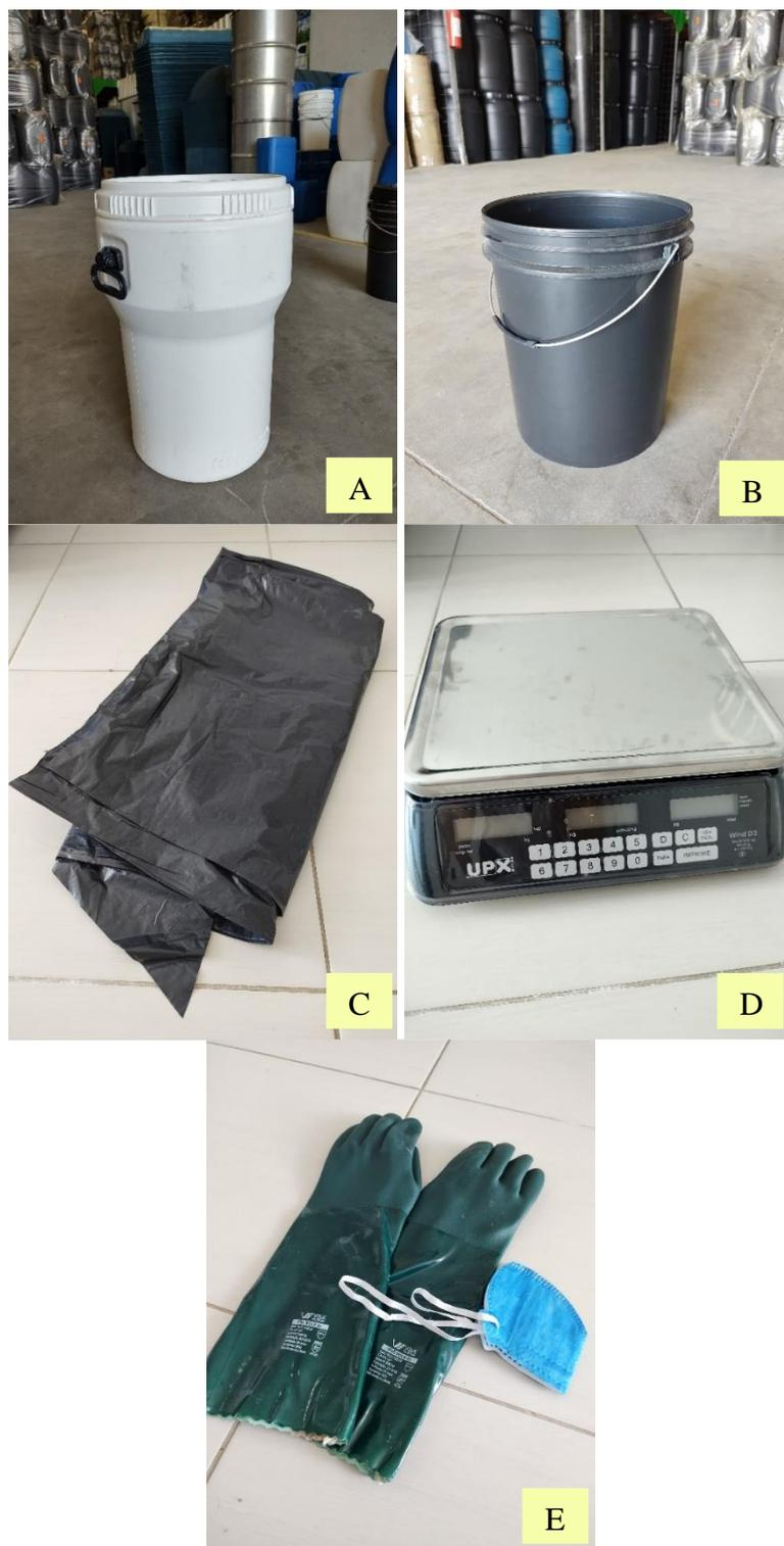
**Figura 7 – Materiais utilizados no presente estudo. (A) Bombona plástica 40 l; (B) Balde plástico 20 l; (C) Lona plástica comum; (D) Balança UPX, Mod. Wind3 N° 3928/20; (E) EPI's luvas de PVC e máscara PFF2S.**
