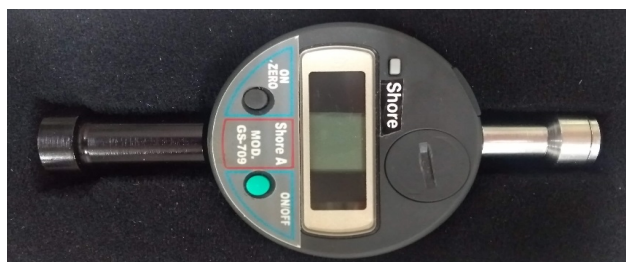
Figura 11: Durômetro Teclock utilizado nas medidas de Dureza Shore A.
