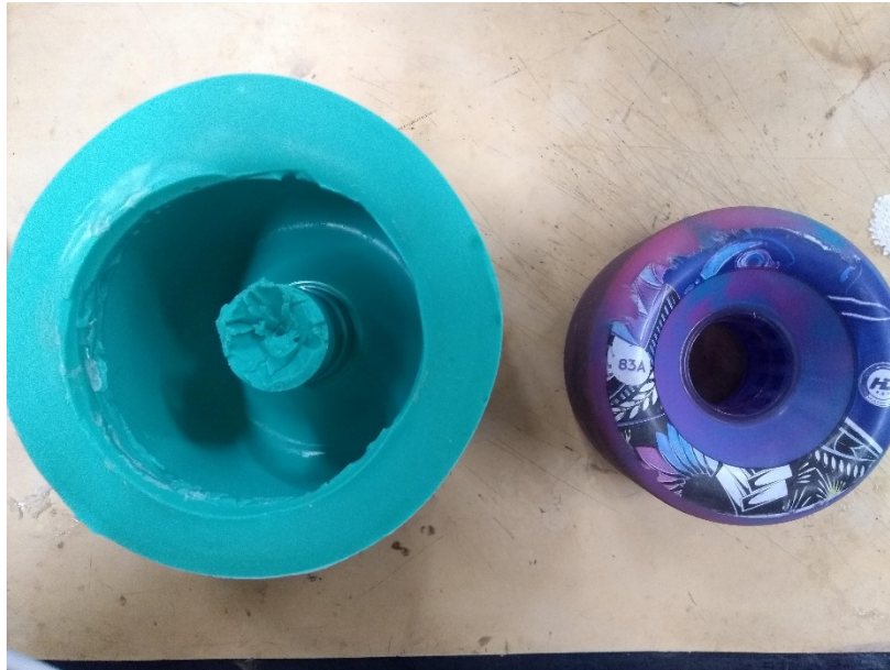
Figura 10: Molde de PlatSil 73-45 ao final do processo de cura, ao lado da roda utilizada como referência.
