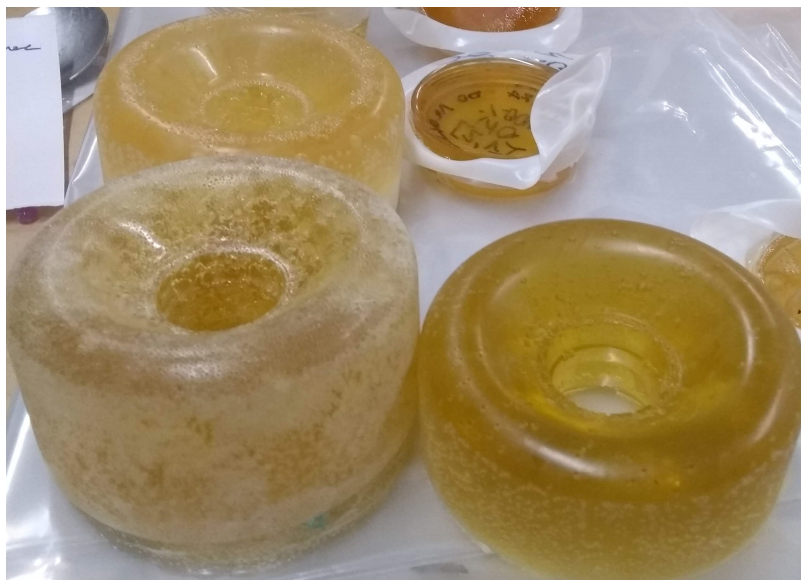
Figura 19: Produto final do projeto, rodas de PU a base de óleo de mamona.
