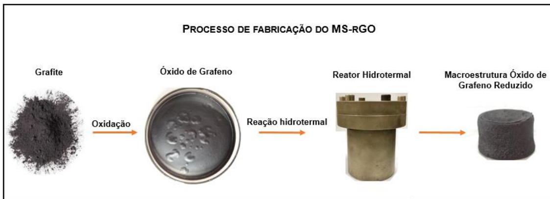
Figura 10. Processo de obtenção do MS-rGO.
