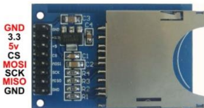
Figura 42 - Detalhe dos pinos do módulo de cartão SD
