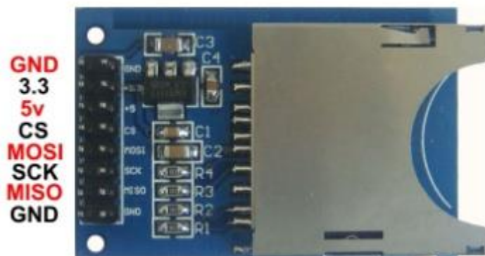
Figura 63 - Detalhe dos pinos do módulo de cartão SD
