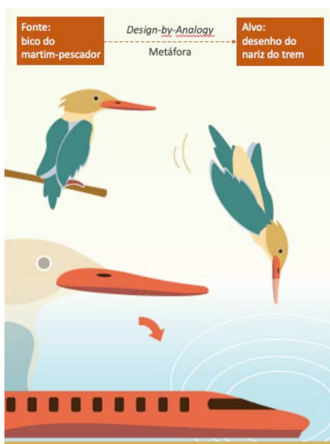
Figura 16: Design do nariz do trem-bala inspirado no bico do martim-pescador.
