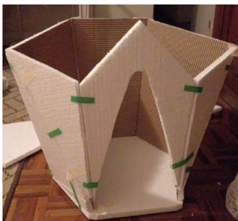
Figura 67: Colagem e montagem das peças da estrutura do modelo
