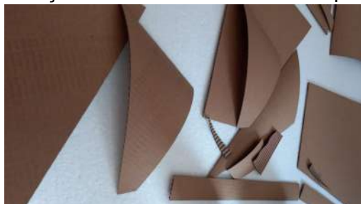
Figura 64: Peças do molde cortados em máquina a laser
