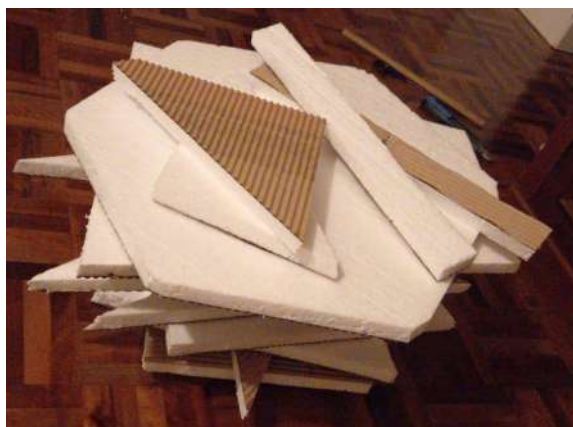
Figura 66: Corte da chapa de isopor 15mm nas peças finais da estrutura do modelo
