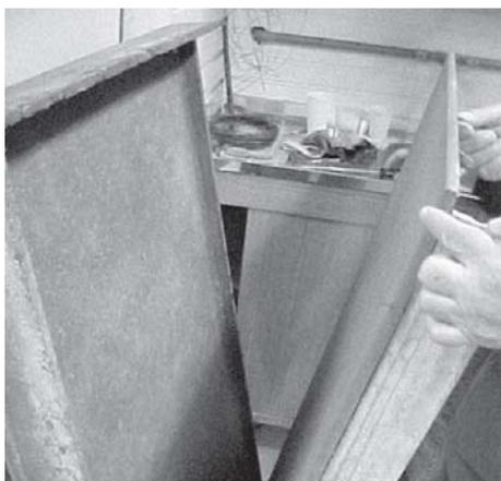
Figura 39: Desmolde do box em GRC
