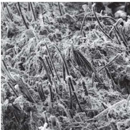
Figura 7 - MEV. Vista geral de fibrocimento com arrançamento de fibras sintéticas
