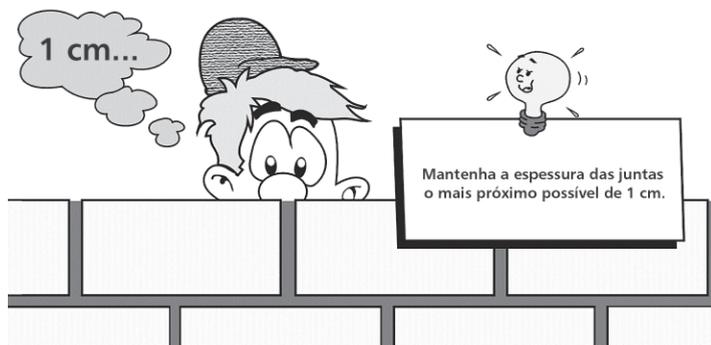
Figura 10 – Detalhe de juntas de argamassa nas alvenarias
