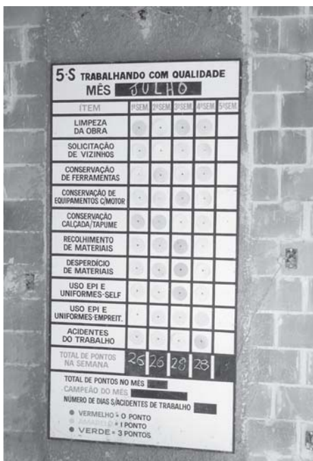
Figura 3.7 - Exemplo de quadro de apresentação de resultados do Programa 5S de fácil compreensão
