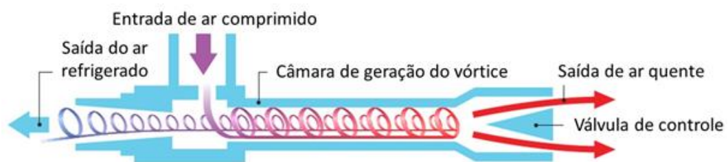
Figura 2.3 – Esquema de um tubo de vórtice [Vortec, 2020].
