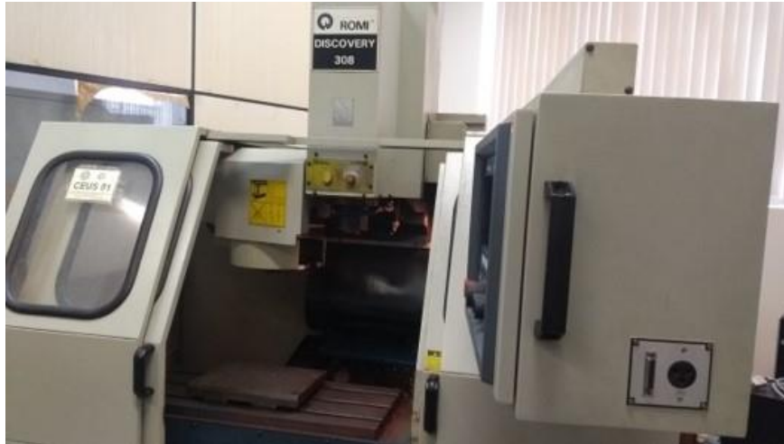
Figura 3.4 – Centro de usinagem ROMI Discovery 308
