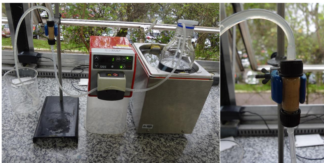
Figura 12. Fotografias do sistema contendo o reator utilizado no experimento, contendo o biocatalisador SiTi-QT15enz.
