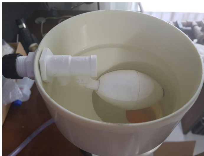
Figura 9.1 - Dispositivo de boia instalado no recipiente de alimentação para a manutenção do nível d'água constante.
