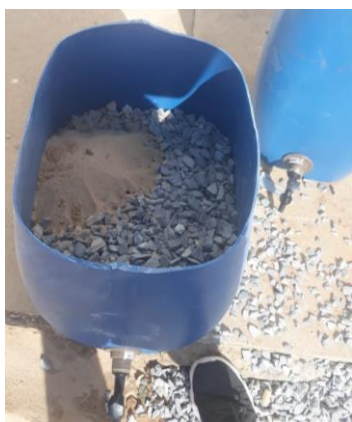
Figura 53: Camada de brita nº 1 e pó de pedra peneira Fonte: Autores (2021)
