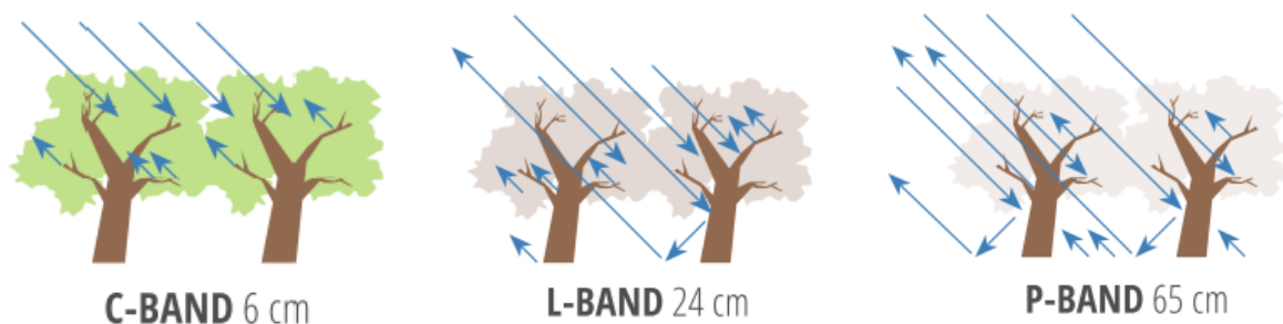
Figura 4: Penetração no dossel e interação com diferentes porções florestais para as bandas C, L e P. Percebe-se maior transparência do dossel florestal para a banda P em relação à banda L, apesar da total penetração destas no dossel.
