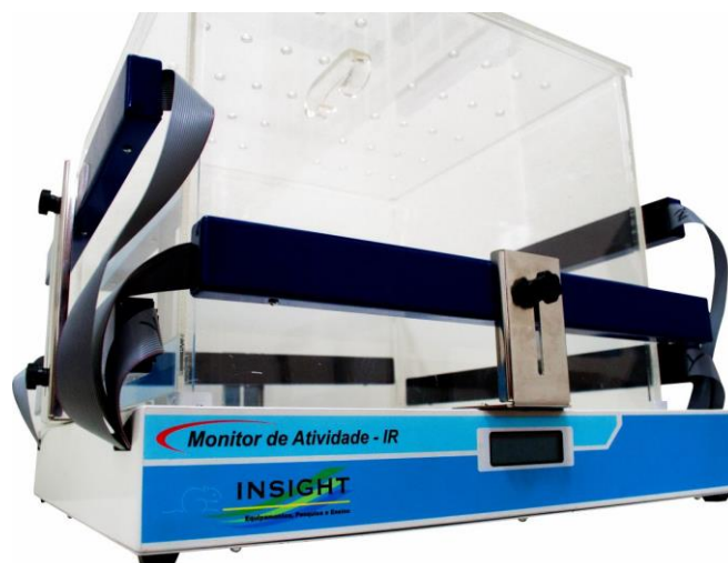
Figura 3. Equipamento monitor de atividade IR (Insight Equipamentos Ltda, Ribeirão Preto, Brasil). Fonte: < https://insightltda.com.br/produto/ep-149-monitor-de-atividades-ir/ >
