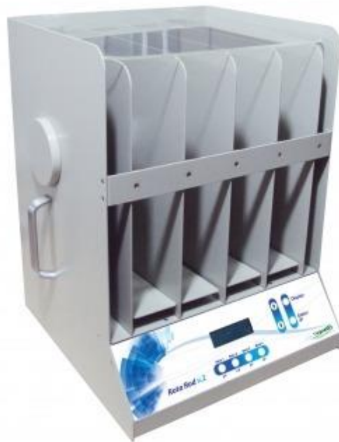
Figura 2. Equipamento Rota-rod para ratos (Insight Equipamentos Ltda, Ribeirão Preto, Brasil). Fonte: < https://insightltda.com.br/produto/eff-411-rota-rod-para-ratos/ >
