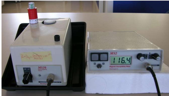
**Figura 16.** Instrumento utilizado para análise de suscetibilidade magnética
