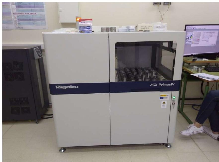
**Figura 10.** Equipamento de análise de Fluorescência de raios X da Universidad de Córdoba (UCO).
