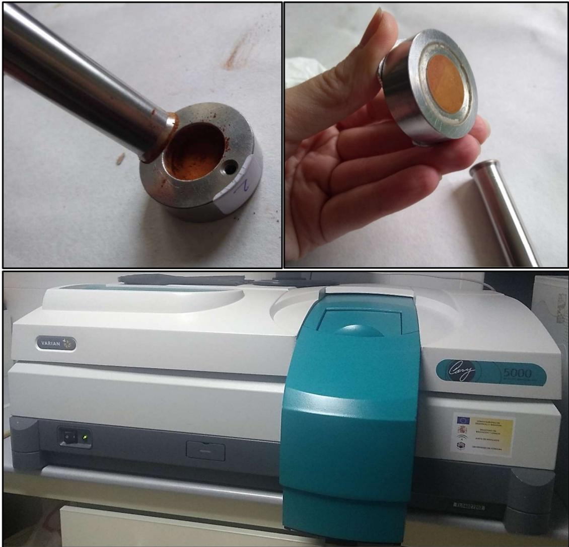
**Figura 17.** Preparação das amostras e equipamento utilizado na leitura da reflectância difusa.
