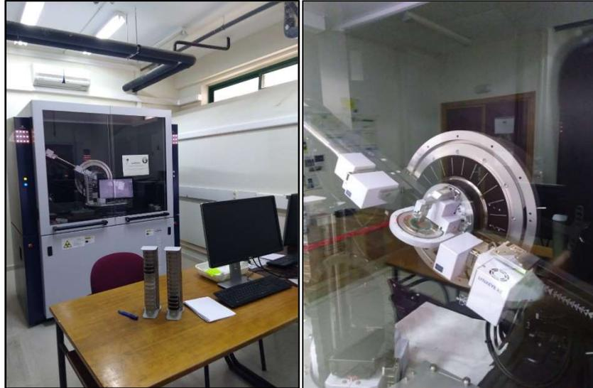
**Figura 8.** Difratorômetro de raios x da Universidad de Córdoba (UCO).
