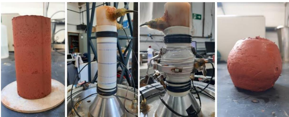
Figura 155 - Amostra antes e após ensaio triaxial com tensão efetiva inicial de 4000 kPa, com amostra remoldada
