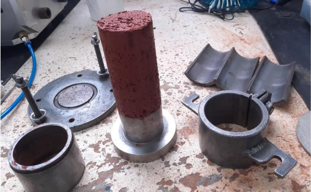
Figura 44 - Molde utilizado para confecção dos corpos-de-prova remoldados
