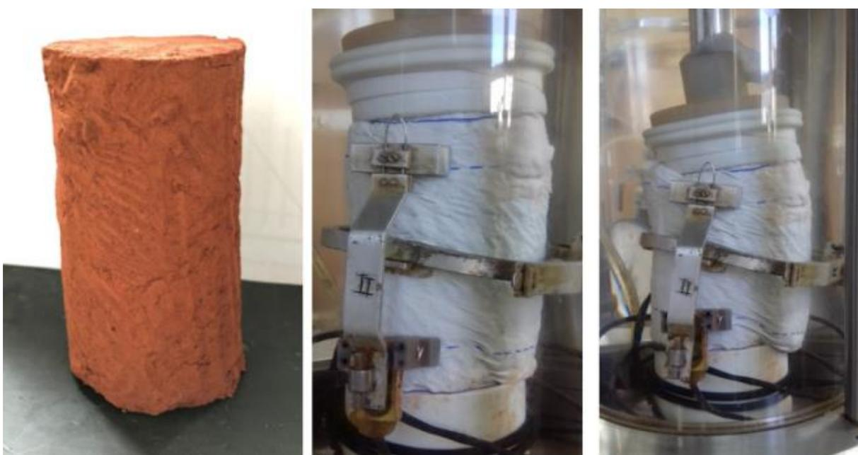
Figura 145 - Amostra antes e após ensaio triaxial com tensão efetiva inicial de 100 kPa, com amostra indeformada
