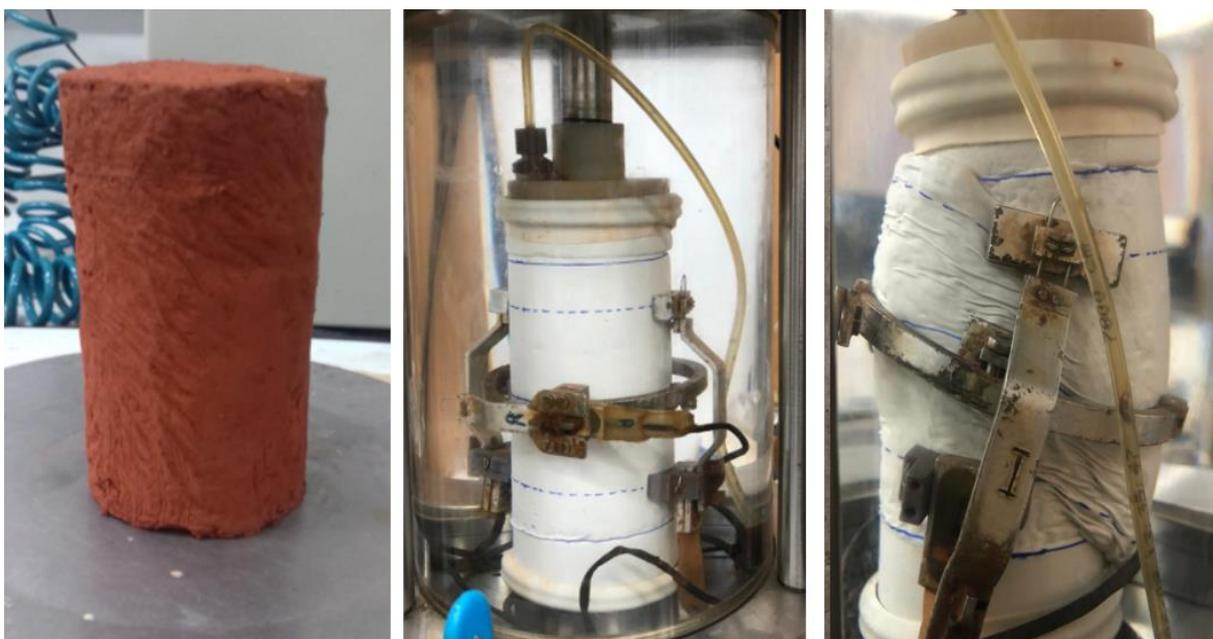
Figura 144 - Amostra antes e após ensaio triaxial com tensão efetiva inicial de 50 kPa, com amostra indeformada
