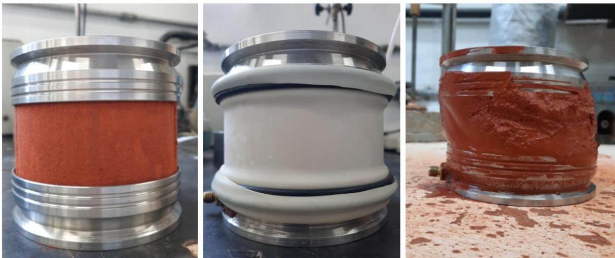
Figura 134 - Amostra antes e após ensaio *simple shear* com tensão vertical efetiva inicial de 25 kPa
