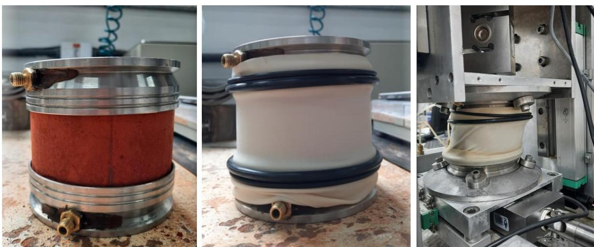
Figura 135 - Amostra antes e após ensaio *simple shear* com tensão vertical efetiva inicial de 50 kPa
