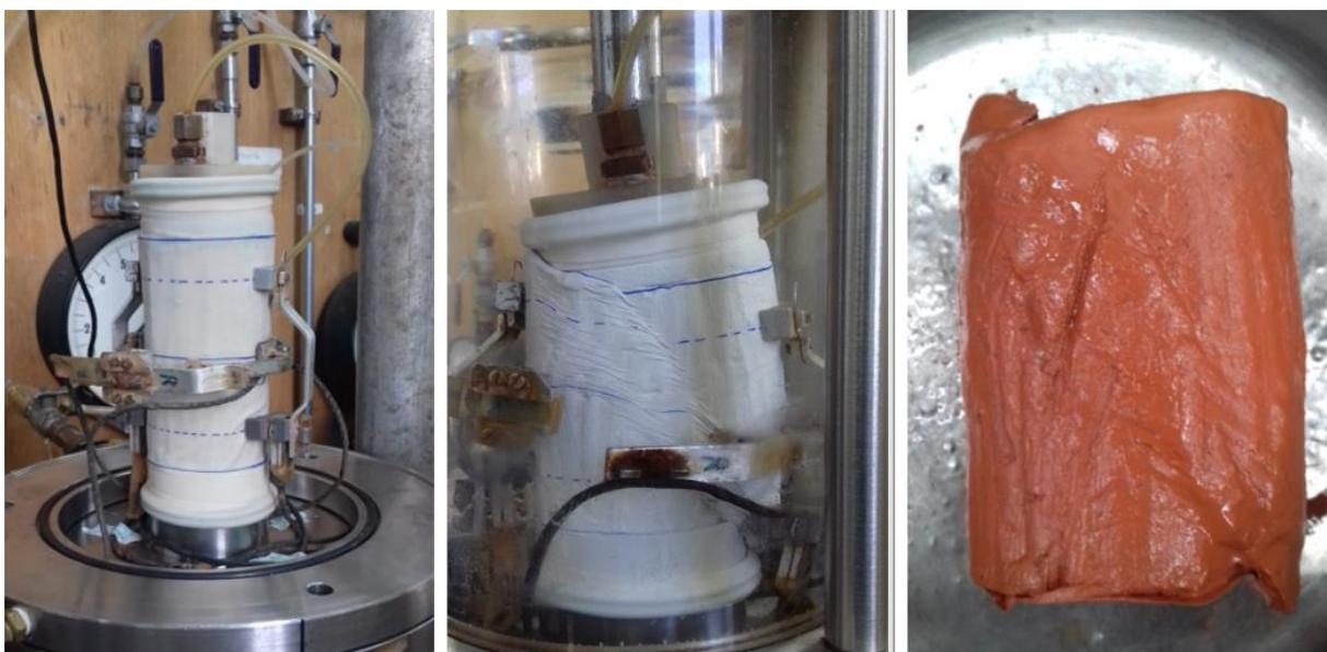
Figura 147 - Amostra antes e após ensaio triaxial com tensão efetiva inicial de 400 kPa, com amostra indeformada
