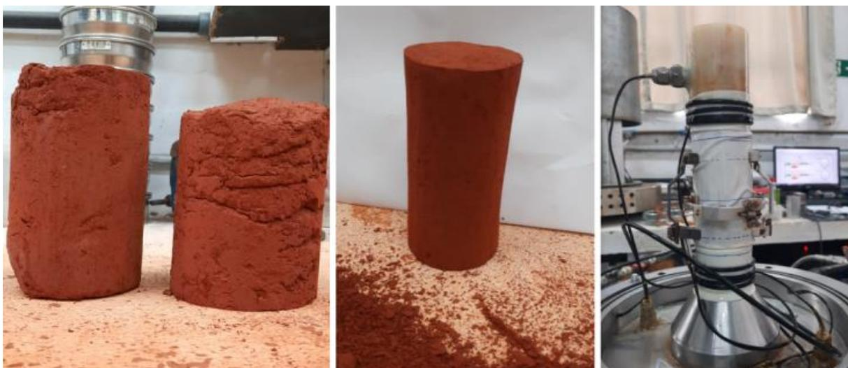
Figura 118 - Amostra para ensaio cíclico com tensão efetiva inicial de 400 kPa e tensão cíclica máxima de 40% da tensão inicial.
