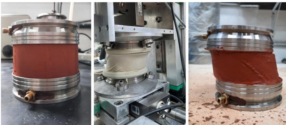
Figura 137 - Amostra antes e após ensaio *simple shear* com tensão vertical efetiva inicial de 200 kPa
