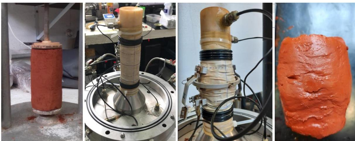
Figura 150 - Amostra antes e após ensaio triaxial com tensão efetiva inicial de 1000 kPa, com amostra indeformada
