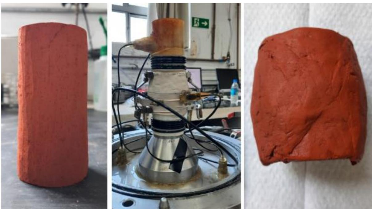
Figura 156 - Amostra antes e após ensaio triaxial com tensão efetiva inicial de 4000 kPa, com amostra indeformada
