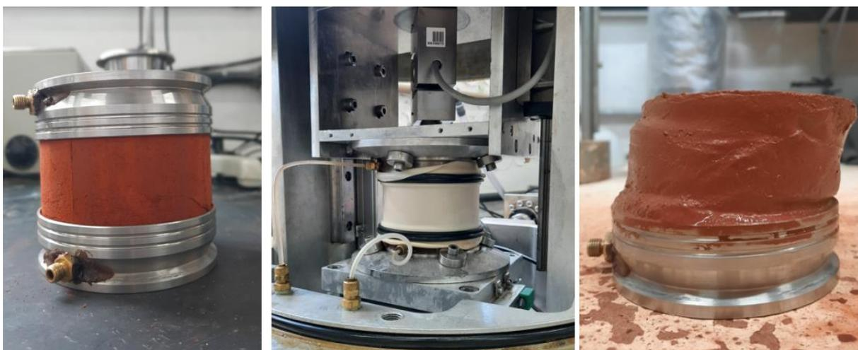
Figura 136 - Amostra antes e após ensaio *simple shear* com tensão vertical efetiva inicial de 100 kPa
