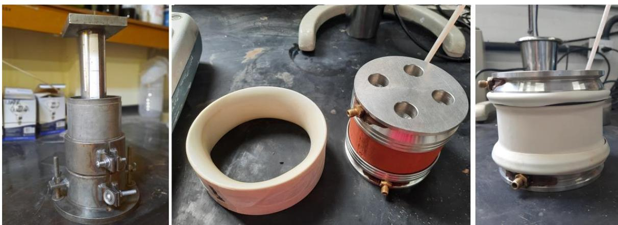
Figura 55 - Processo de preparação dos corpos-de-prova para ensaios *simple shear*
