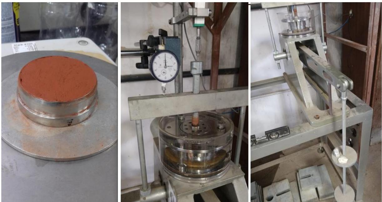
Figura 40 - Ensaio Oedométrico: a) Corpo de Prova no anel para ensaio; b) Célula de Adensamento; c) Equipamento para realização do ensaio.
