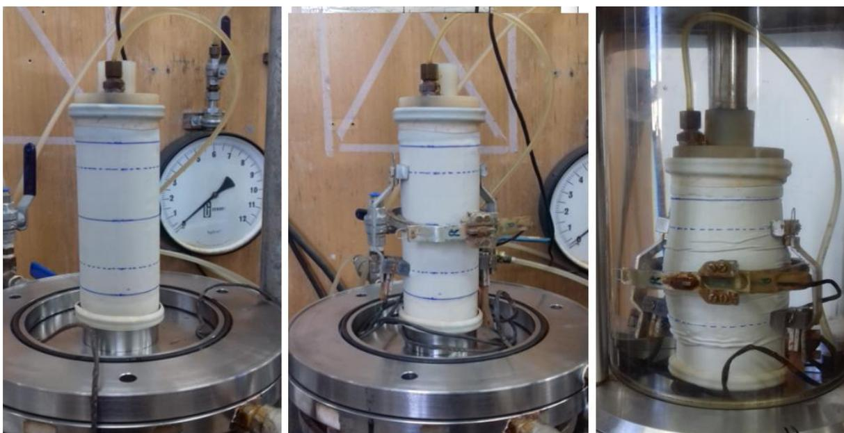
Figura 146 - Amostra antes e após ensaio triaxial com tensão efetiva inicial de 100 kPa, com amostra remoldada
