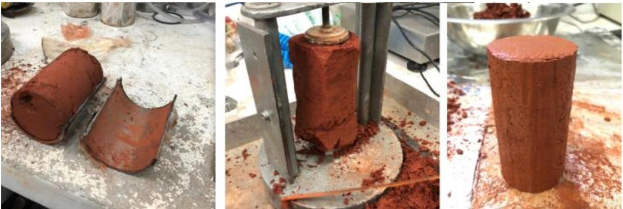
Figura 42 - Preparação do corpo-de-prova de uma amostra indeformada
