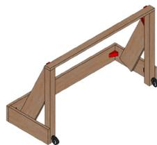
5. Encaixar as rodinhas com parafusos, garantindo que fiquem levemente acima do chão, para permitir movimento da goleira quando inclinada
