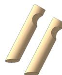
4. Cortar 2 toras de 50cm. Fazer um chanfro de 60° na base e um chanfro de 5cm de profundidade a 4,5cm do topo para encaixar o encosto na tora transversal da plataforma.
