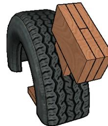
Colocar as tábuas de 10x20 cm de forma perpendicular para formar a cabeça do cavalinho. Utilize a tábua de 10x10 para preencher o vão criado na frente.
