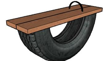
Com o pneu já cortado, colocar tábuas de madeira nas extremidades, para manter o formato e criar uma superfície de fixação para o assento da gangorra. Caso sinta necessidade, apare os cantos das tábuas para melhor encaixe.
