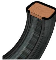
Para manter a forma dos pneus, colocar tábuas de 10x15 cm nas extremidades. Pode ser necessário moldar as pontas para melhor encaixe.
