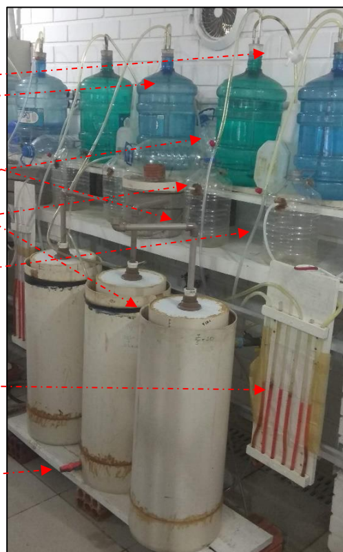
Figura 3. Esquema de montagem do biodigestor e do medidor de biogás.
