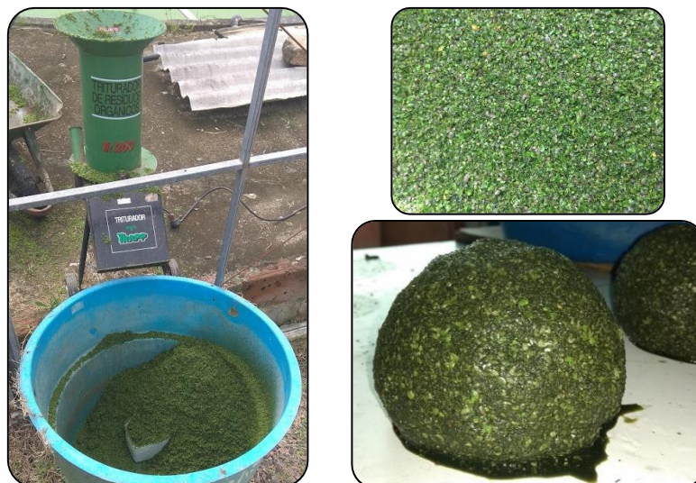
Figura 6. Triturador TR 200 (esquerda) e macrófitas trituradas (direita).
