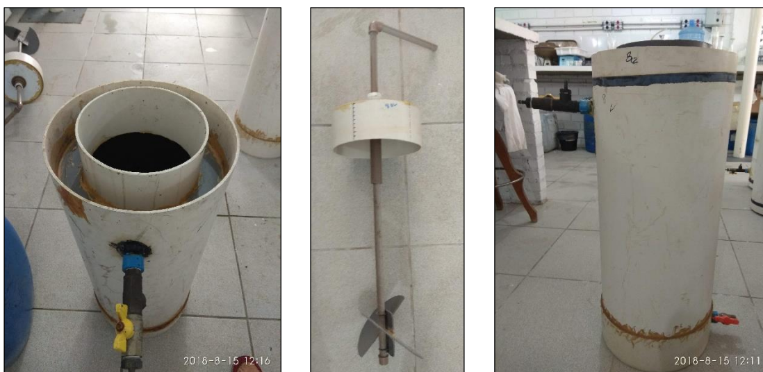
Figura 2. Biodigestor empregados nos testes co-digestão anaeróbia de macrófitas e lodo anaeróbio.
