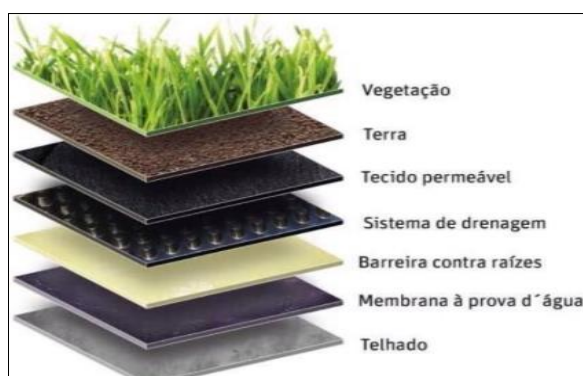
Figura 6: Exemplo de estrutura do telhado verde.
