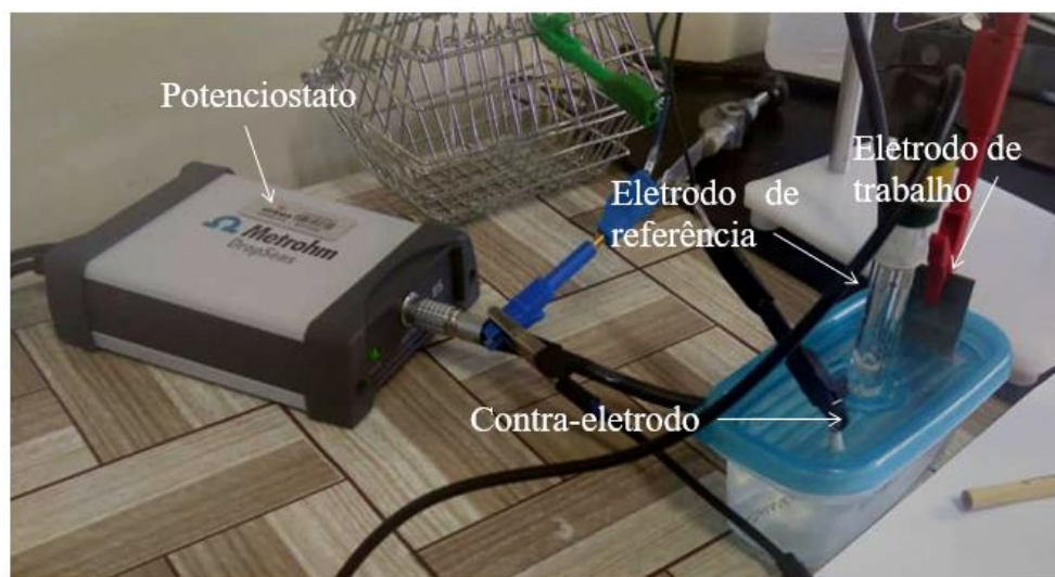
Figura 3. Potenciostato e célula eletroquímica utilizada nos ensaios eletroquímicos.
