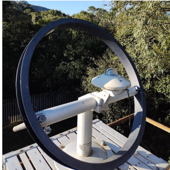
Figura 2: Piranômetro com anel de sombreamento acoplado para realizar medição de radiação solar difusa horizontal.
