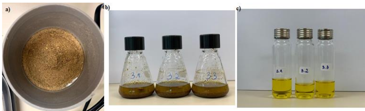
Figura 1: (a) Pó seco da casca da banana prata; (b) amostras ao final do tempo de agitação, pré-filtração; (c) amostras pós-filtração dos resíduos sólidos.
