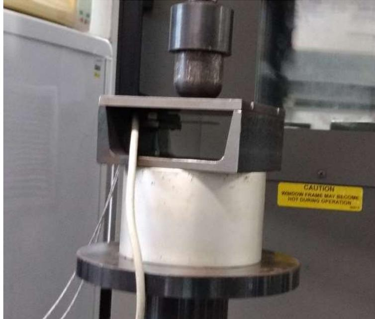
Figura A 2 - Protótipo sendo submetido à carga pontual
