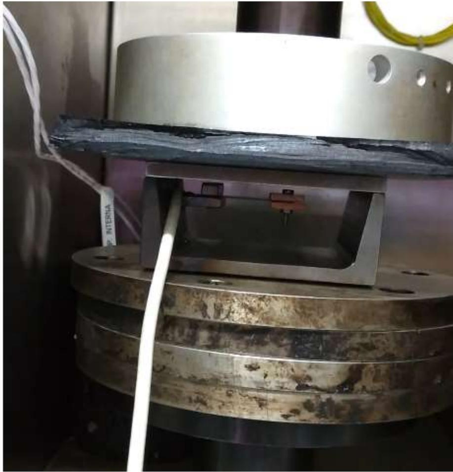
Figura A 3 - Prensa com impacto no corpo de prova através da borracha
