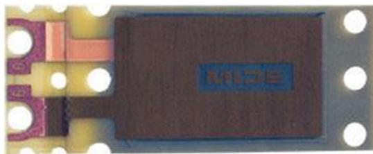
Figura 22 - Transdutor Piezoelétrico PPA-1014, escolhido para o experimento
