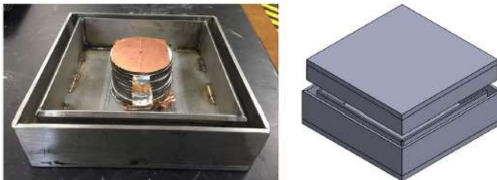
Figura 6 - Protótipo de discos de PZT e caixa de proteção para aplicação. FONTE: Roshani et al. (2018)
