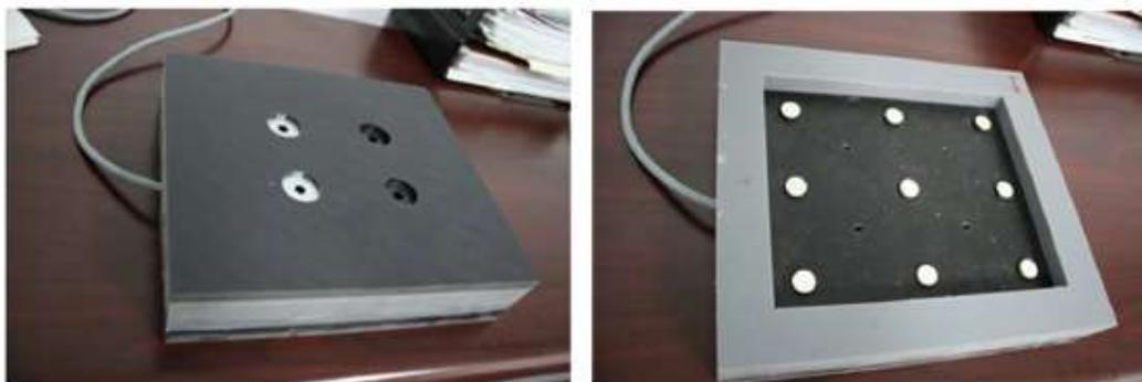
Figura 10 - Protótipo de Coleta de Energia (PEH) testado em trecho experimental. FONTE: Xiong e Wang (2016)
