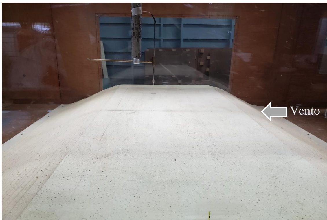
Figura 56 – Modelo reduzido sinusoidal 2D para ângulo 20^\circ , com extensão do cume igual a 3H.
