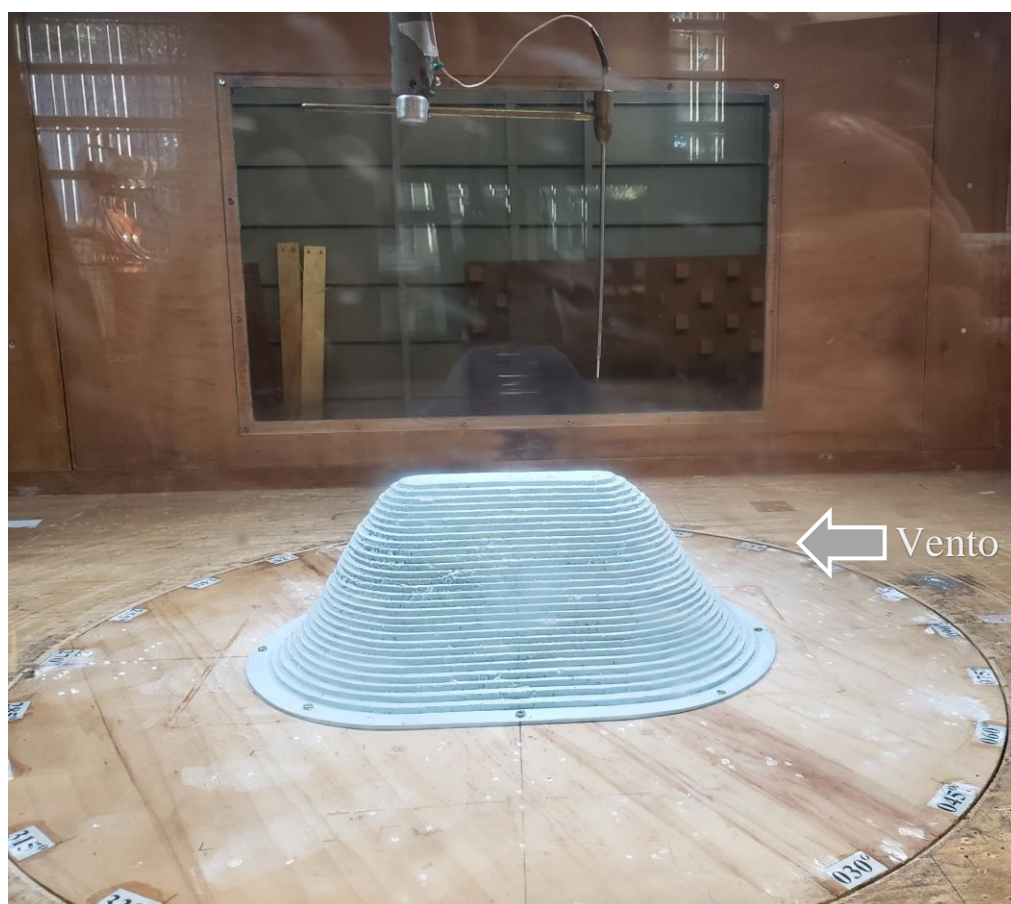
Figura 53 – Modelo reduzido sinusoidal 3D para ângulo 45^\circ , com extensão do cume igual a 1H
