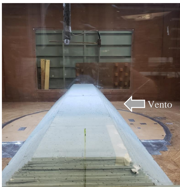
Figura 62 – Modelo reduzido triangular 2D para ângulo 45^\circ , com extensão do cume igual a 1H .
