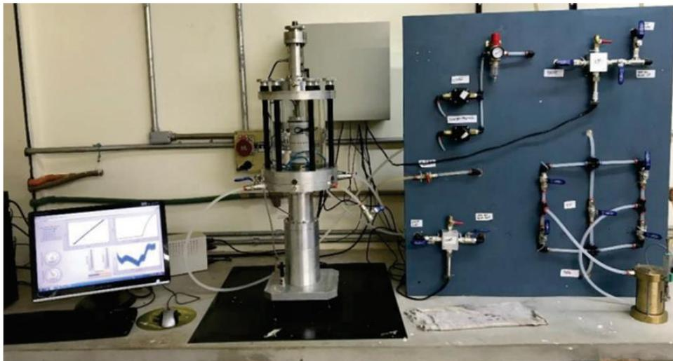
Figura 4.10: Equipamento para ensaio triaxial
