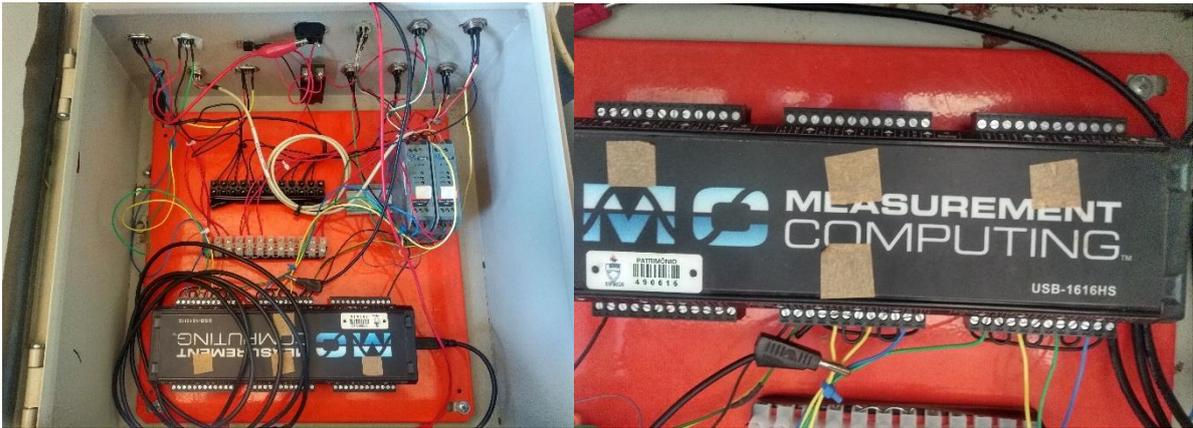
Figura 4.35: Caixa de aquisição de dados
