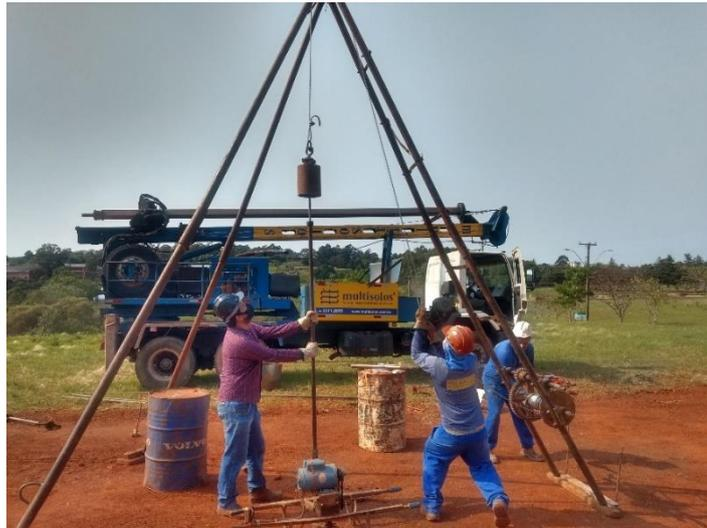
Figura 4.8: Execução do ensaio de sondagem à percussão
