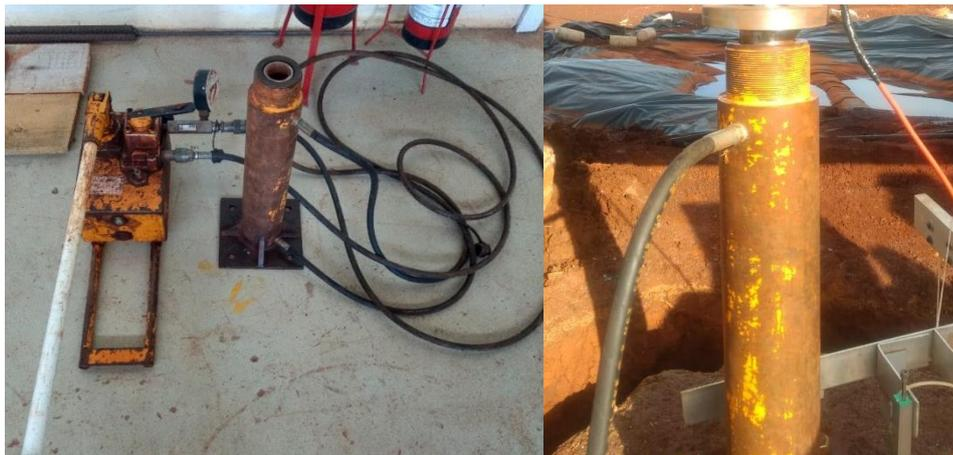
Figura 4.17: Cilindro hidráulico e bomba manual
