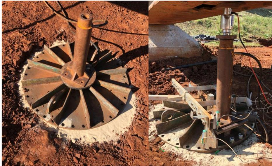
Figura 4.39: Montagem do sistema de transmissão de carga e medição e aquisição de dados
