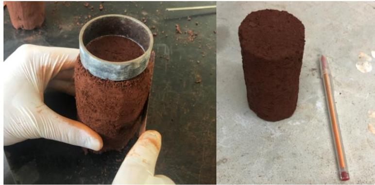
Figura 4.4: Moldagem dos corpos de prova indeformados
