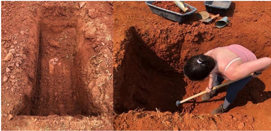
Figura 4.1: Coleta de amostras indeformadas
