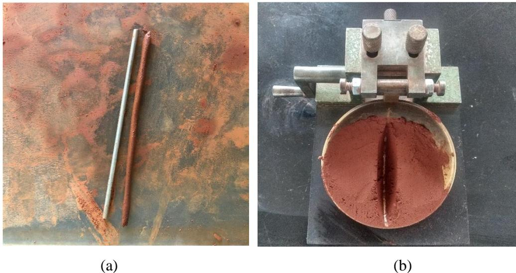
Figura 4.6: (a) Ensaio de limite de plasticidade (b) Ensaio de limite de liquidez
