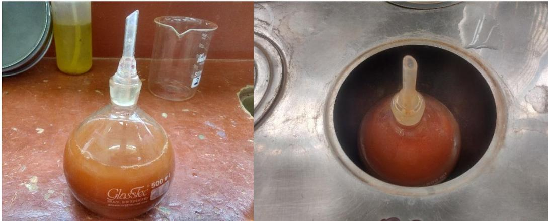
Figura 4.7. Execução do ensaio de massa específica dos grãos
