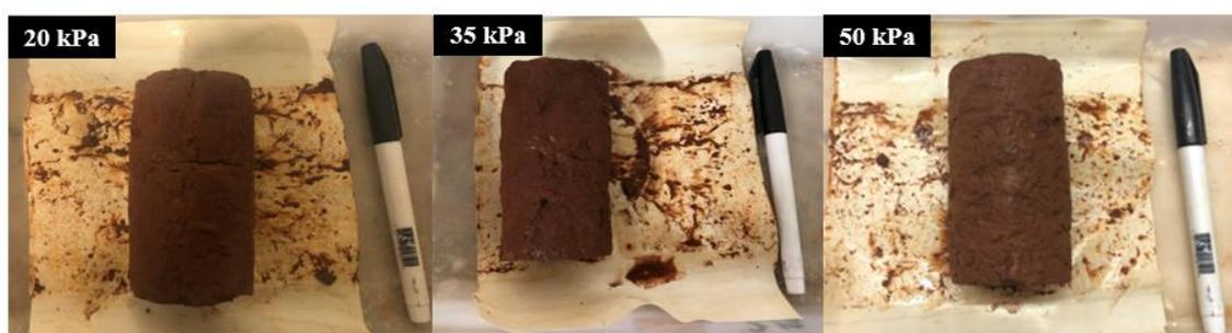
Figura 5.5: Amostras deformadas após os ensaios triaxiais
