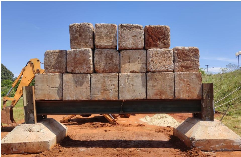
Figura 4.16: Sistema de reação
