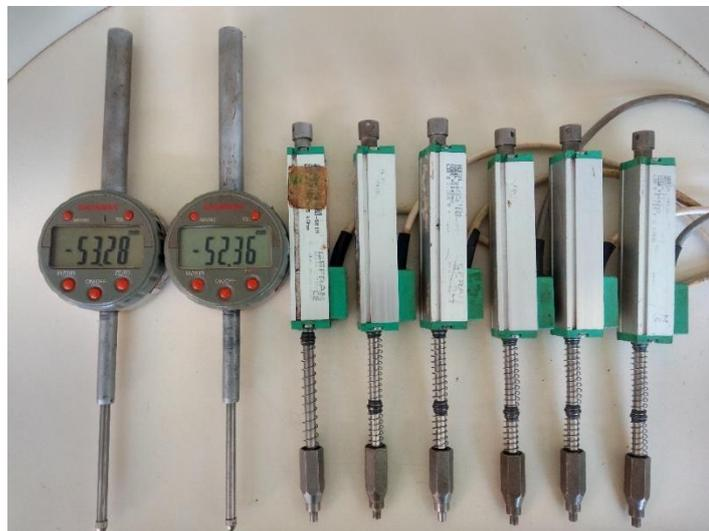
Figura 4.31: Medidores de deslocamento
