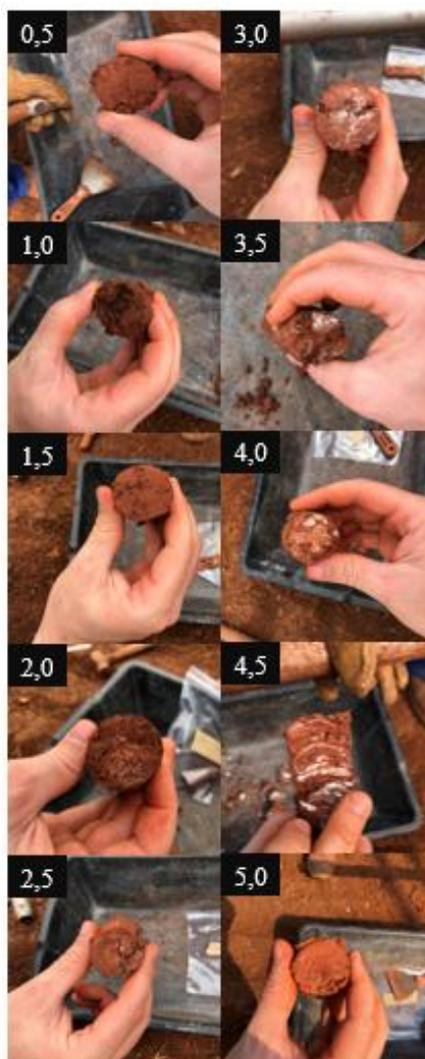
Figura 5.4: Amostras coletadas do SPT
