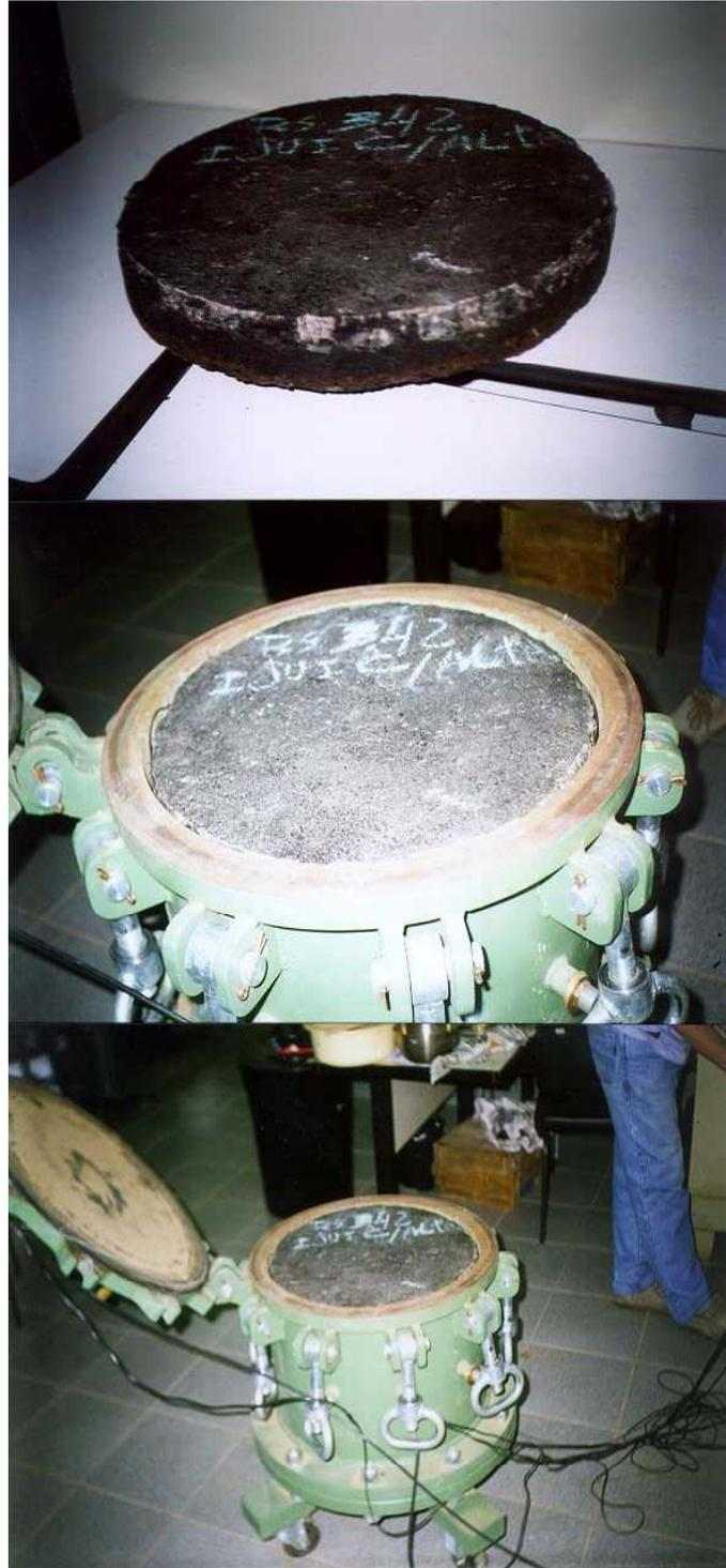
Figura 4.34: Testes com uma placa de CBUQ
