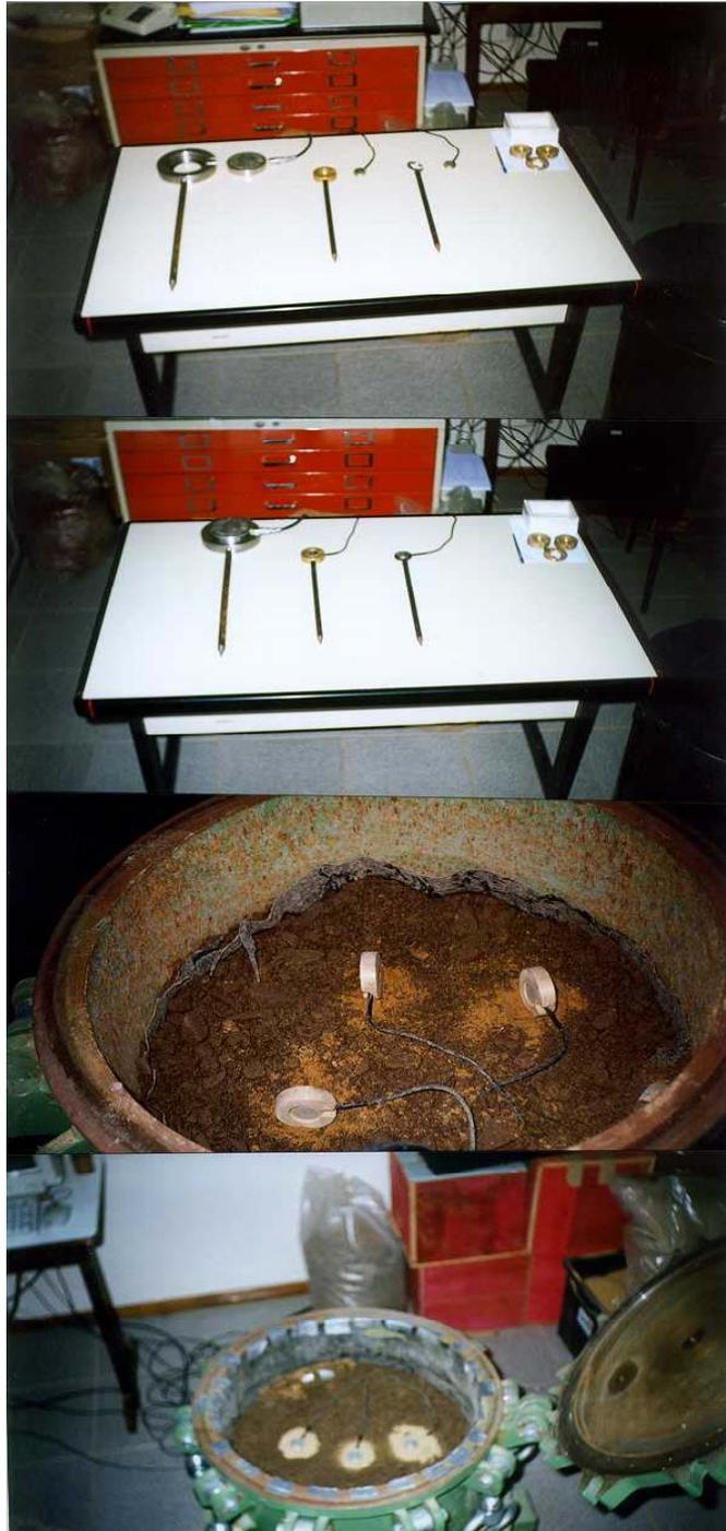
Figura 4.31: Instalação das células com os dispositivos de fixação utilizados no campo
