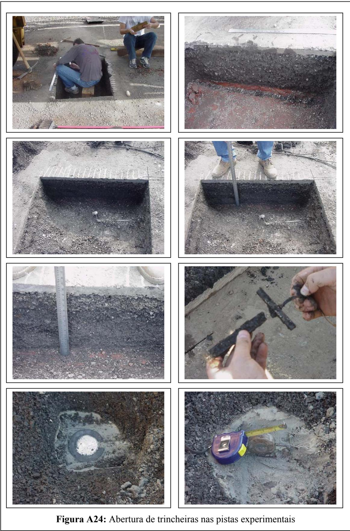
**Figura A24:** Abertura de trincheiras nas pistas experimentais
