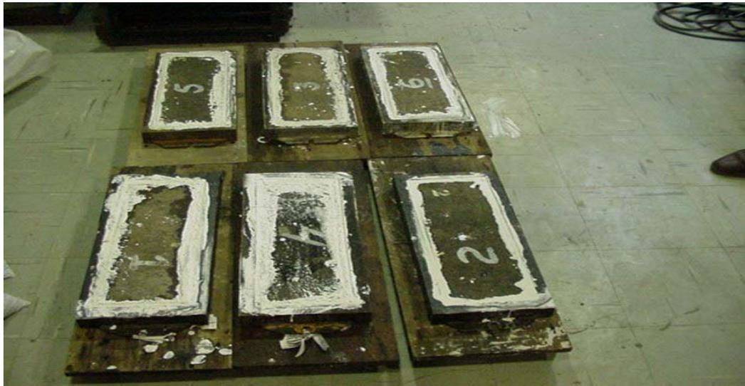
Figura 3.22: Corpos de prova extraídos das seções experimentais para ensaios de ATR
