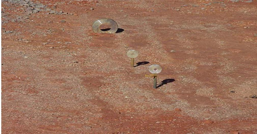
Figura 4.56: Dispositivos para instalação de células para medição de tensões horizontais e verticais durante a compactação da brita graduada
