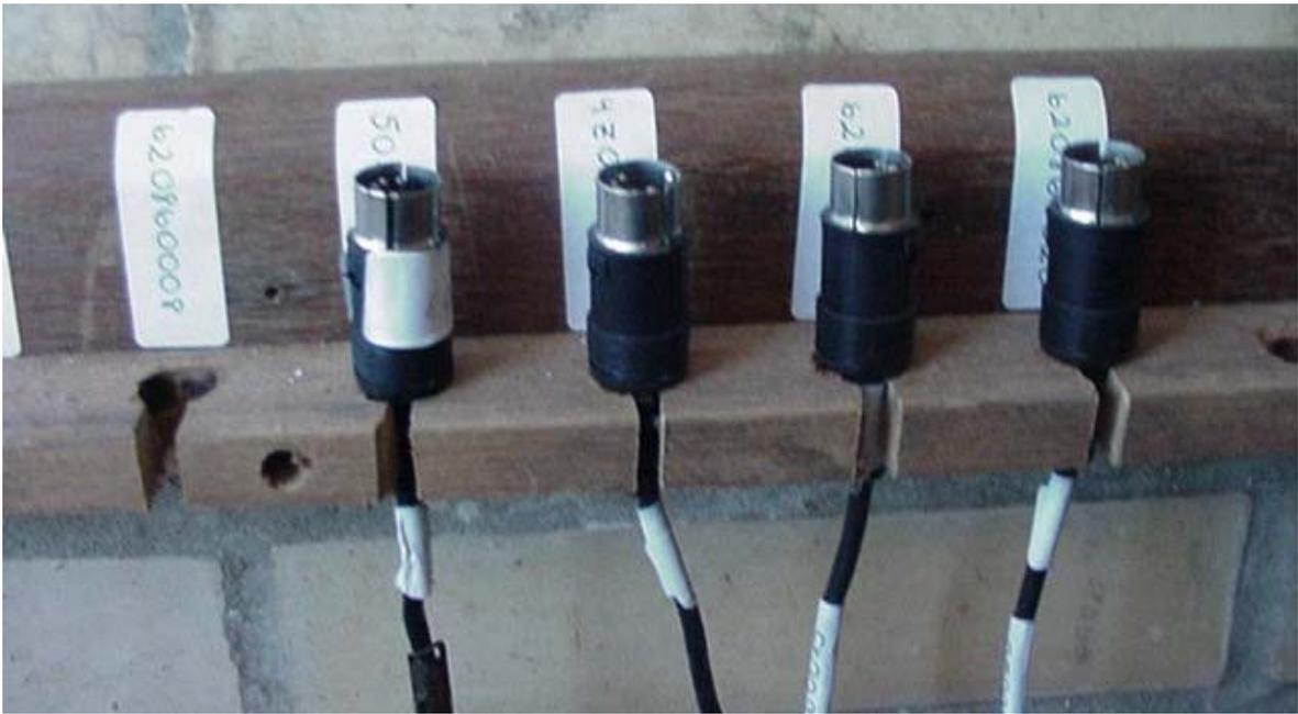
Figura 4.51: Conectores para aquisição de dados no campo
