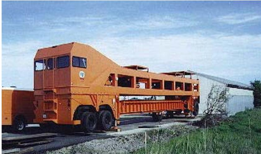
Figura 2.1: Heavy Vehicle Simulator (Fonte: <http://www.its.berkeley.edu/techtransfer/>)
