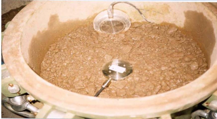
Figura 4.28: Instalação de células nas posições vertical e horizontal em brita graduada
