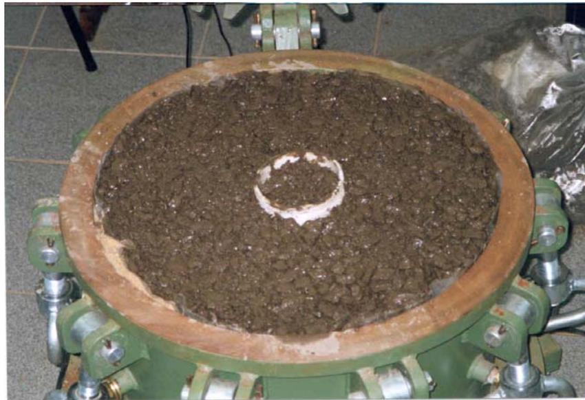
Figura 4.29: Câmara de calibração com brita graduada compactada
