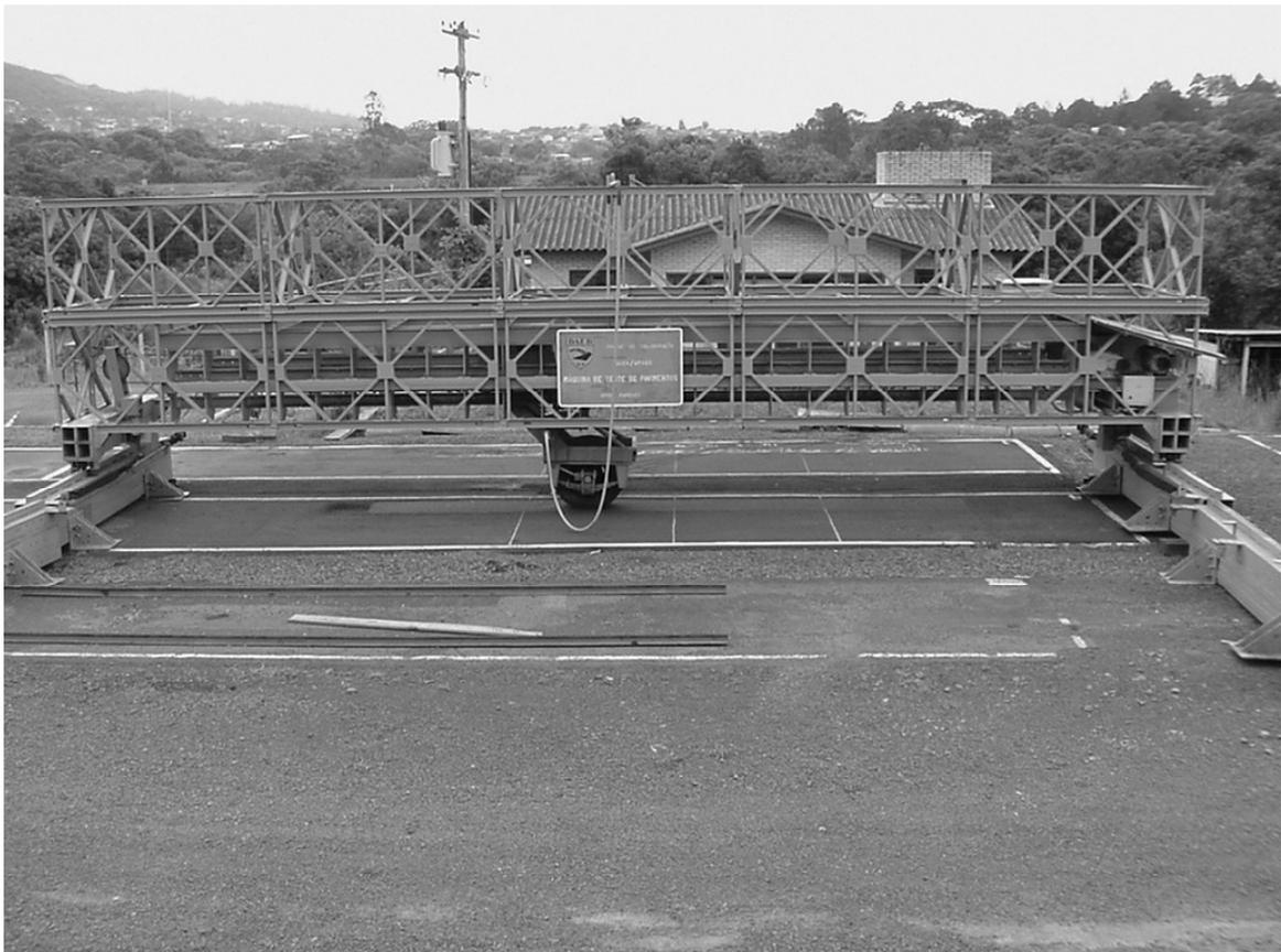
Figura 5.1: Simulador linear de tráfego UFRGS-DAER (vista lateral)
