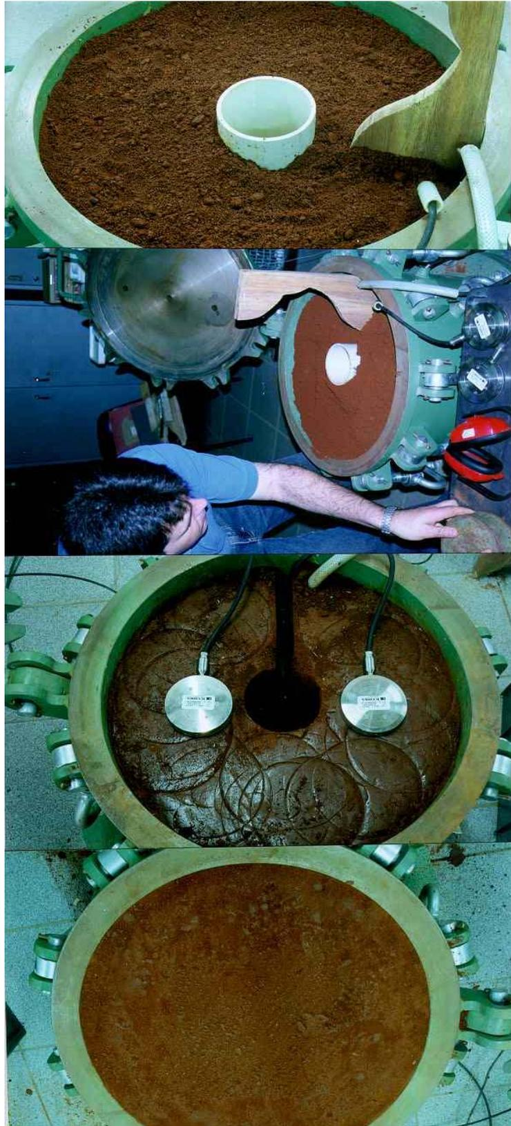
Figura 4.18: Instalação de células em solo argiloso
