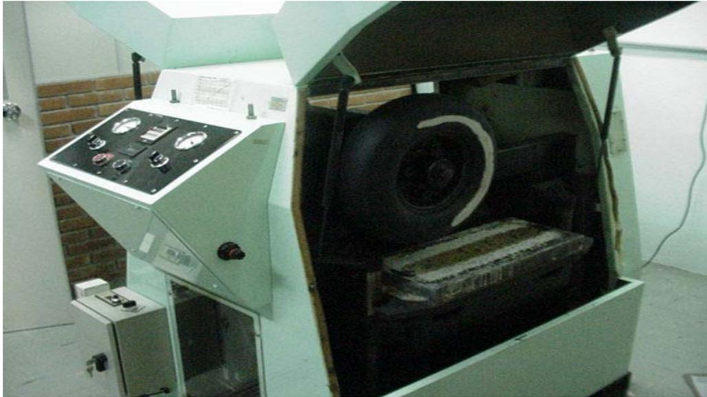
Figura 3.21: Simulador de tráfego tipo LCPC do LTP da EPUSP
