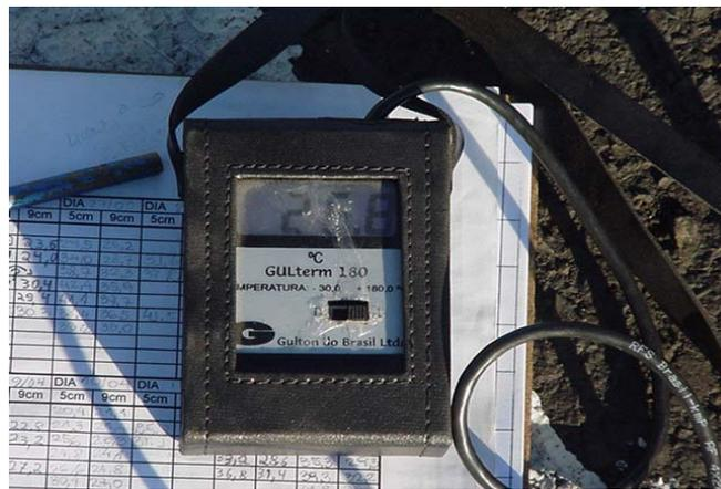
Figura 6.50: Termômetro digital para determinação da temperatura do CBUQ
