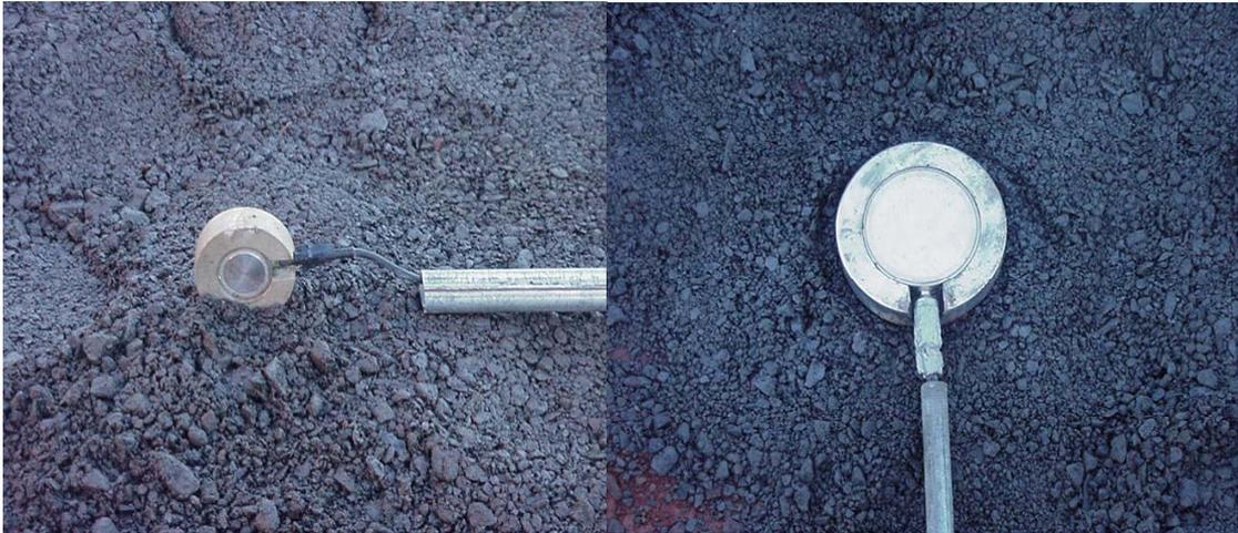
Figura 4.57: Instalação de células no interior da brita graduada
