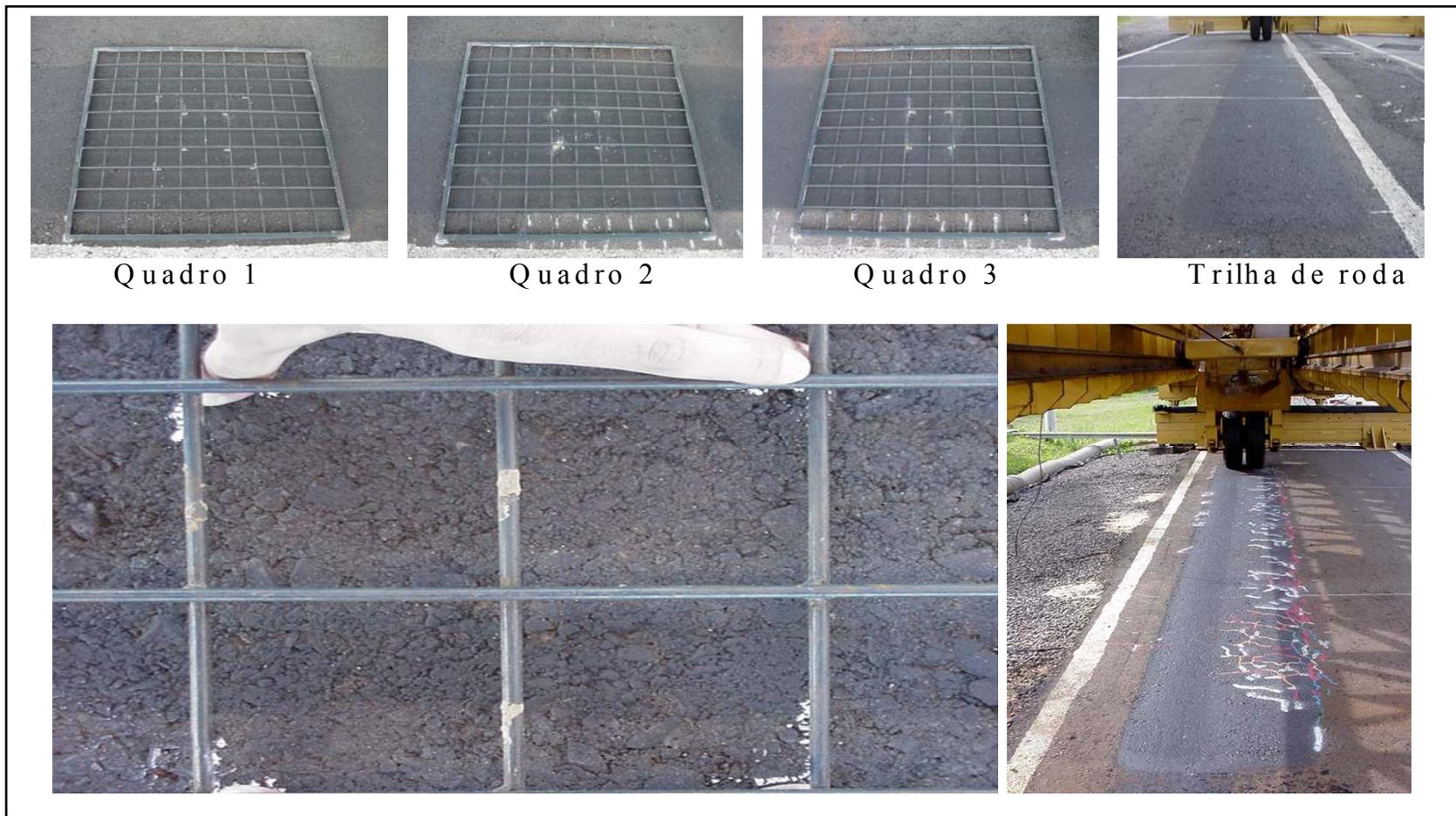
Figura 6.33: Grade metálica de referência utilizada para avaliação do trincamento (escala)
