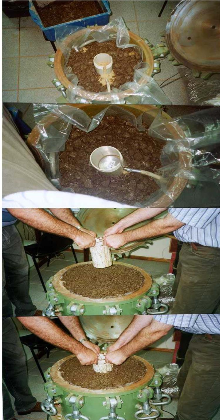
Figura 4.30: Instalação de células para calibração em brita graduada
