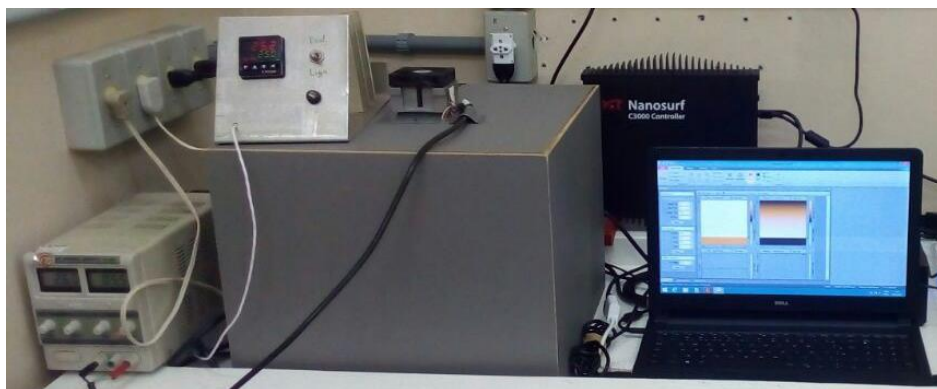
Figura 11: Sistema de resfriamento do equipamento de microscopia de força atômica desenvolvido para controle de temperatura e minimização de ruídos.
