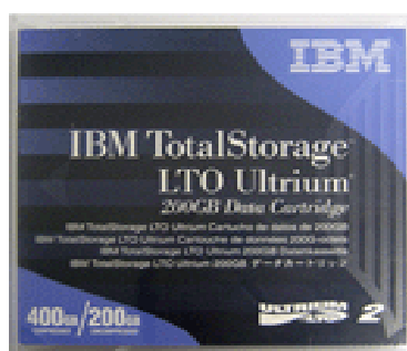
Figura 17 – Fita magnética LTO / IBM para backup (capacidade de armazenamento de 400GB)
