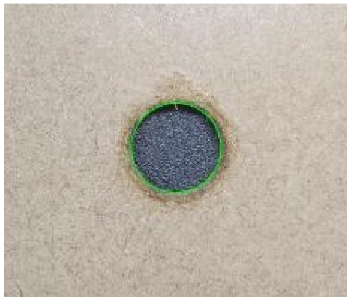
Figura 15: Furo detectado pela transformada de Hough para círculos.
