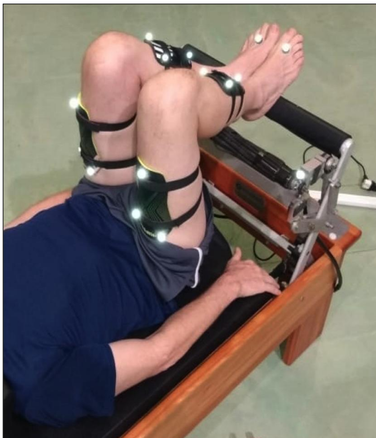
Figura 6 - Marcadores reflexivos e clusters utilizados durante as etapas de coleta de dados.
