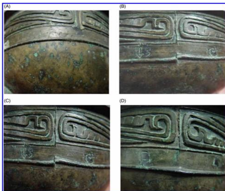
Figura 7 Testes em amostras real (A) pátina da superfície, (B) antes da aplicação, (C) pós aplicação e (D) cinco anos após aplicação.
