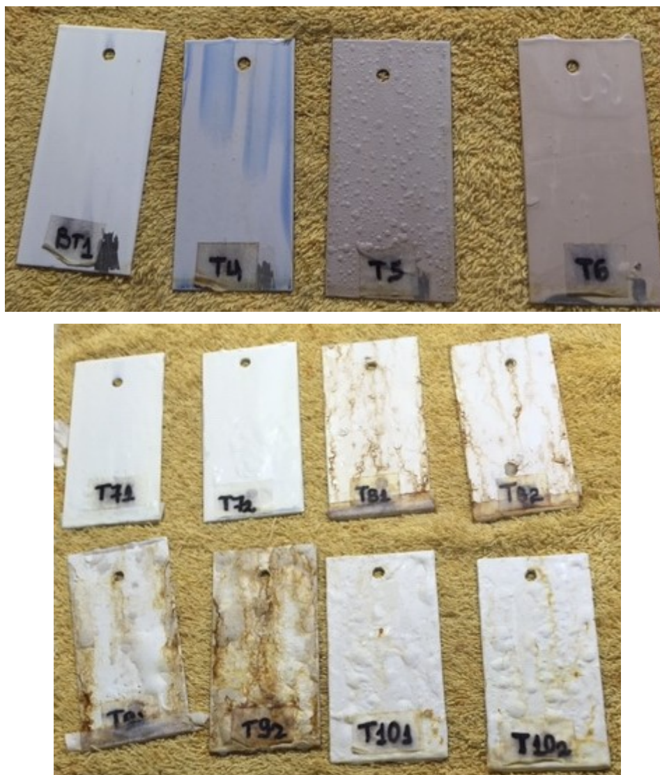
Figura 68. Placas de alumínio da liga AA 5052 pintadas com tinta base solvente (BT, T4, T5, T6) e com tinta base água (T7, T8, T9, T10), após 1320 h de exposição ao ambiente salino.
