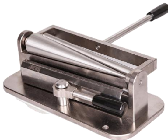
Figura 5: Mandril cônico para teste de flexibilidade.
