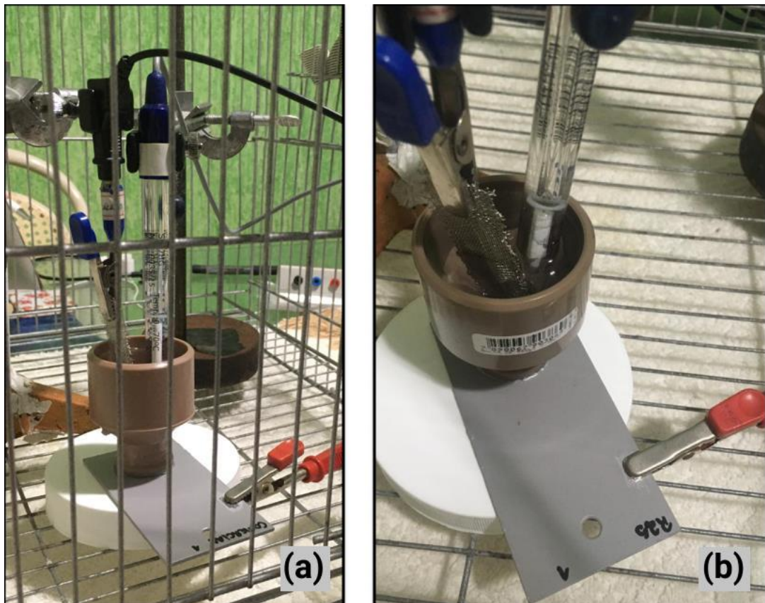
Figura 7: Célula montada para a execução do teste, contendo o contra-eletrodo de platina, o eletrodo de trabalho e o eletrodo de referência de ECS.
