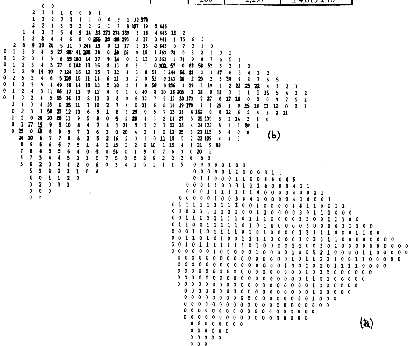
FIGURA 5.2 - Os limites da bacia hidrográfica e rede de drenagem obtida por digitalização (a) e análise do MNT (b).
