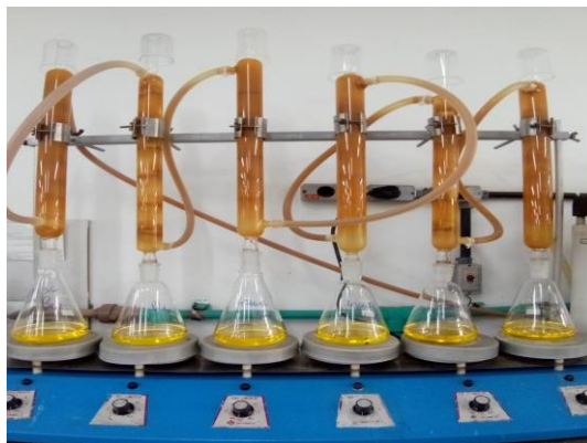
Figura 1 – Sistema de refluxo aberto para determinação da DQO por método titulométrico.
