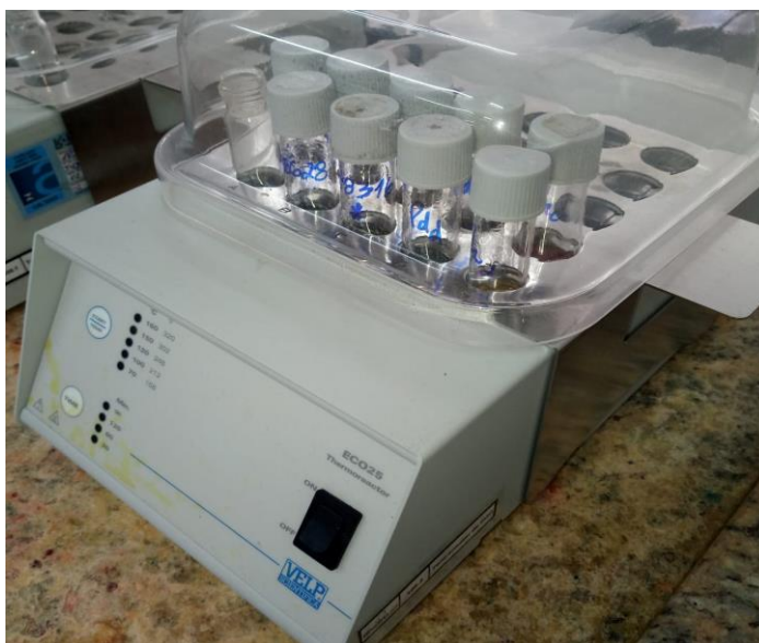
Figura 2 – Sistema de refluxo fechado (bloco digestor) para determinação da DQO por método colorimétrico.
