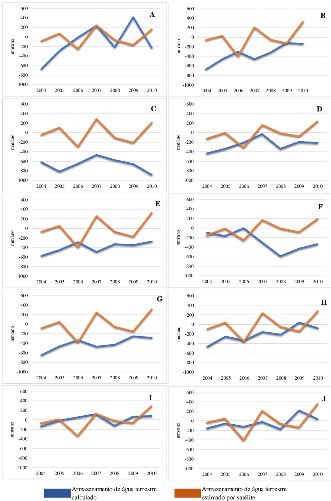
Figura 20. Armazenamento de água terrestre anual estimado por sensoriamento remoto e observado para cada bacia de estudo. A) PDC; B) PRT; C) CCH; D) PCA; E) CMO; F) BCA; G) SAN; H) PSL; I) IRA; J) PLU.
