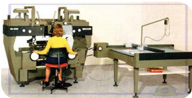
ESTÉREO PLOTTER aparelho utilizado para visualização e restituição das informações das fotografias aéreas
