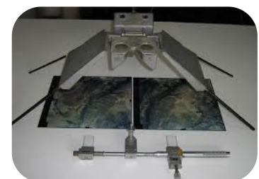
estereoscópio de espelho para uso em laboratório
